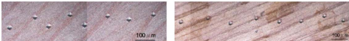
Abbildung 24: Erscheinungsbild der Scherbänder an der Oberfläche eines Kupfer-Einkristalls [192] nach einem (links) beziehungsweise zwei (rechts) ECAP Schritten
