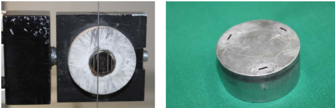
Abbildung 31: Sägen der einzelnen Ermüdungsproben (links) und Probenvorbereitung für Schleifen/Polieren auf 40 mm Zylinder (rechts)
