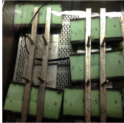
Abb. 5.23: Wasser gelagerte Probekörper während der Tau-Phase
