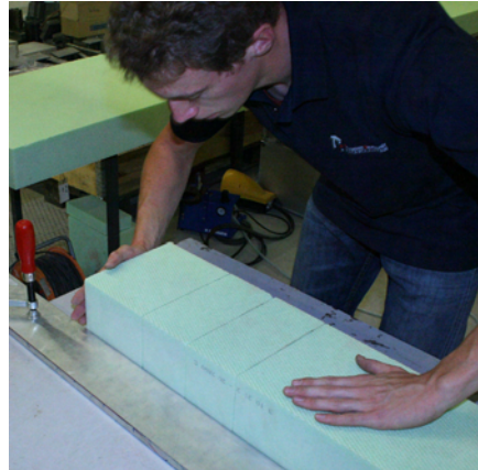
Abb. 5.5: Ausrichten und Andrücken des geklebten XPS-Kerns
