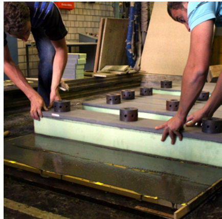
Abb. 5.9: Eindrücken des XPS-Kerns in den Beton am 2. Herstellungstag
