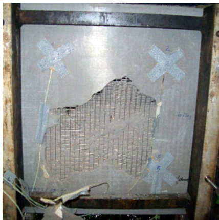
Abb. 9.6: Äußere Deckschicht des ersten Probekörpers nach dem Versuch
