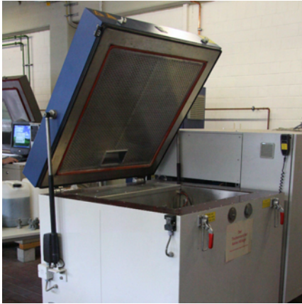
Abb. 5.22: Temperaturkontrollierte Prüfruhe zur Frost-Tau-Prüfung
