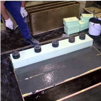
Abb. 5.8: Beschweren des Kerns mit Gewichten
