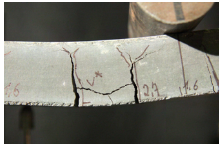
Abb. 7.15: Spaltrissbildung eines carbonbewehrten Betonstreifens in einem Tastversuch
