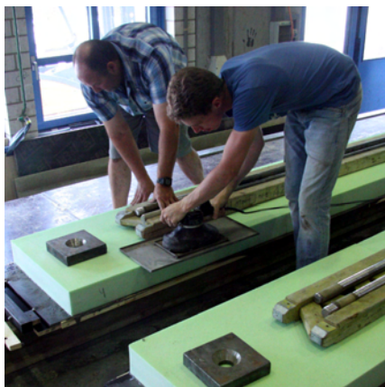
Abb. 5.56: Eindrücken des XPS-Kerns mit Hilfe des Flächenrüttlers
