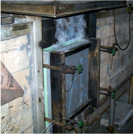
Abb. 9.4: Probekörper 1 nach einer Versuchsdauer von 10 Minuten
