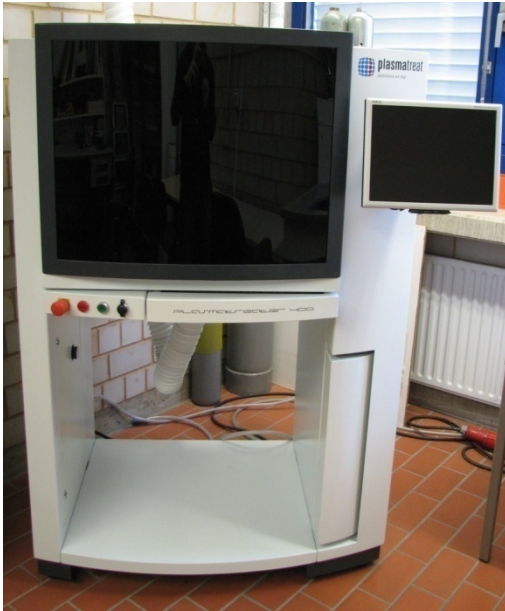
Abbildung 16: Plasmaanlage vom Typ AS 400
