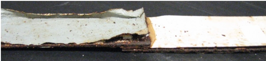
Abbildung 22: Geklebte dünne Zugscherprobe aus bandbeschichtetem Blech nach 10 Wochen Auslagerung im Klimawechseltest VW PV 1200
