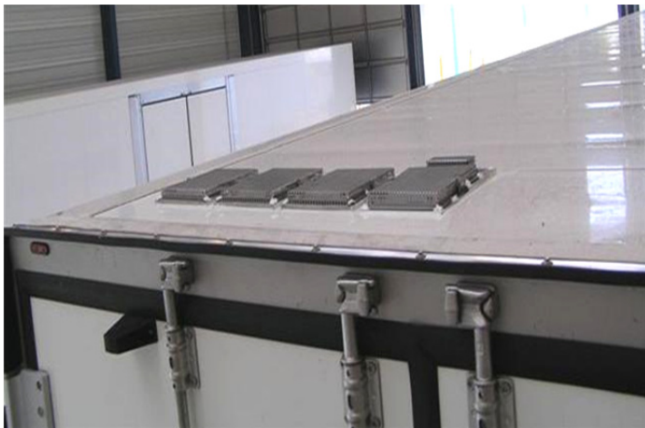
Abbildung 35: Montierte Proben auf dem Dach eines Kühlfahrzeugs
