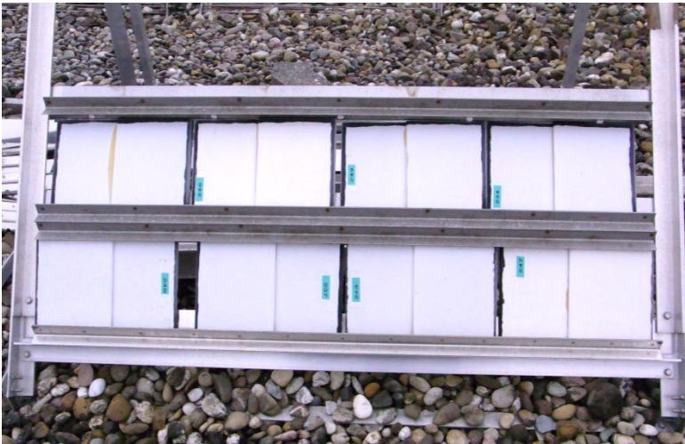
Abbildung 31: Prüfstand für die Freibewitterung nach VDA 621-414
