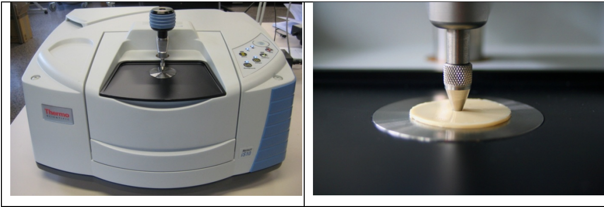
Abbildung 42: FTIR-Spektrometer (links) und Probe auf ATR-Einheit (rechts)
