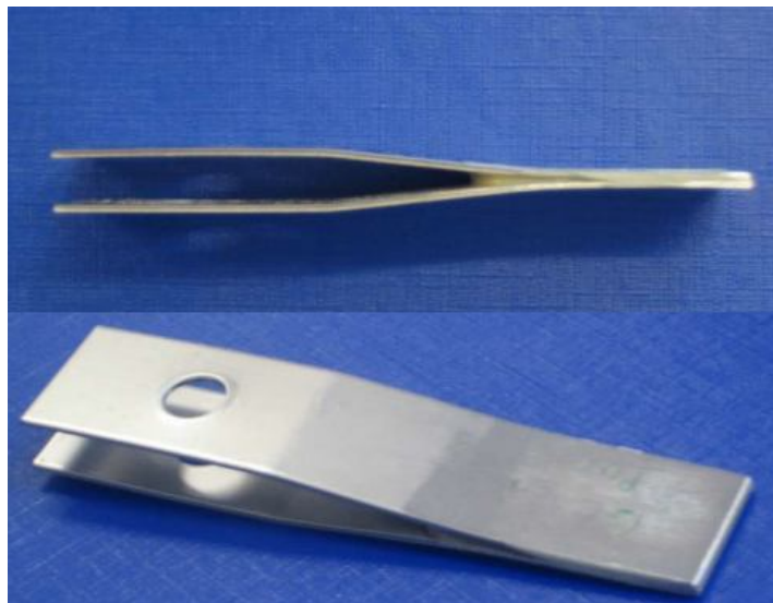
Abbildung 55: Schlag-Schäl-Probe nach dem Kleben der Füge­teile
