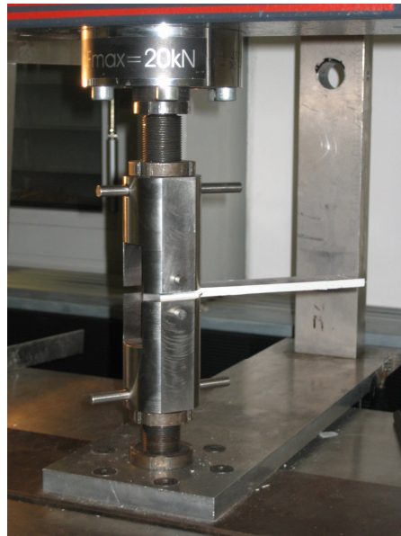
Abbildung 46: Eingespannte Probe bei Double Cantilever Beam-Versuch
