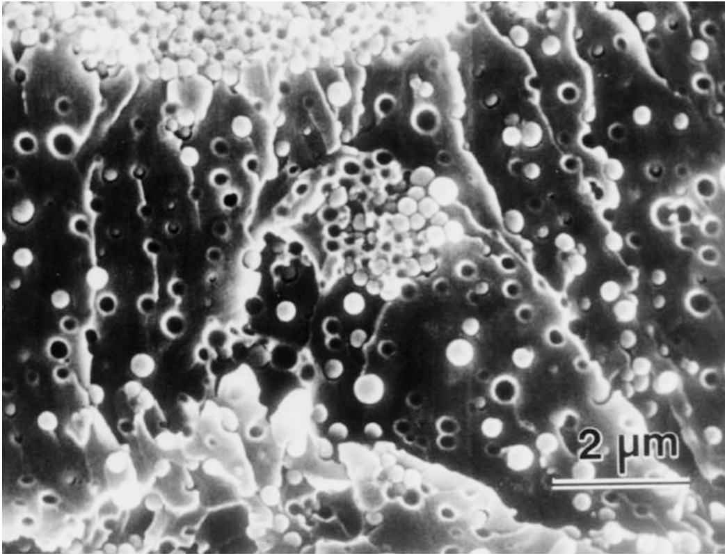
Abb. 5.21: Kryobruch von keramischen \text{SiO}_2 -Partikeln in Epoxidharz bei Inhomogenität und minderer Anbindung [132]
