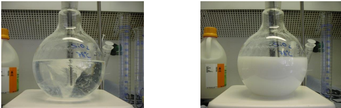
Abb. 4.9: Die \text{SiO}_2 -Lösung mit beginnender Opaleszenz, sowie finale opake Lösung nach der 2. Zugabe TMAH
