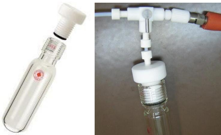
Abbildung 21. Handelsübliche Ace Glass Pressure tube (links) und modifizierter Deckel (rechts).
