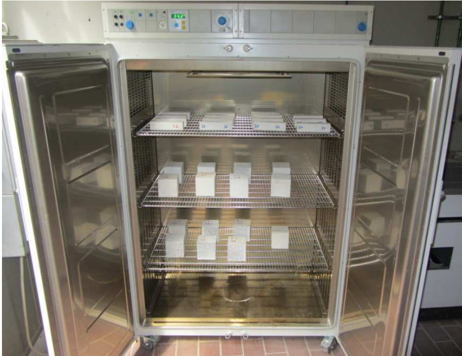
Abb. 4.16: Probekörper (nicht gegen Austrocknung geschützt) bei der Wärmebehandlung
