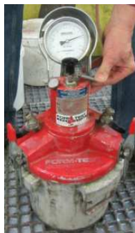
Abb. 4.6: Bestimmung des Luftgehaltes gemäß DIN EN 12350-7
