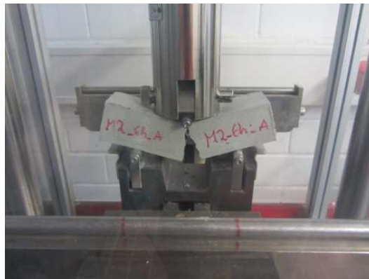
Abb. 4.10: Dreipunktbiegeversuch nach DIN EN 12390-5
