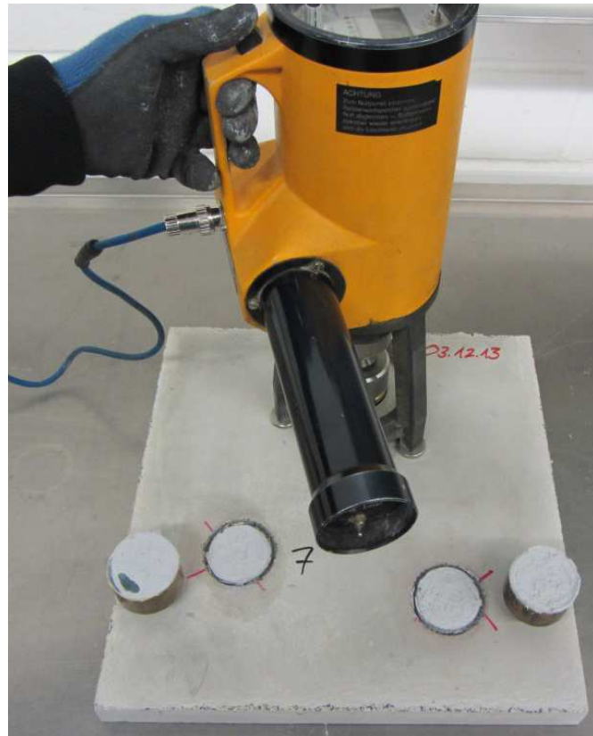
Abb. 8.13: Abreißprüfung zur Ermittlung der Haftzugfestigkeit zwischen Nanodur ® -Beton und PVD-beschichtetem Aluminiumblech
