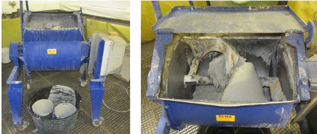
Abb. 4.3: ELBA Labor-Zwangsmischer EMS 60 C
