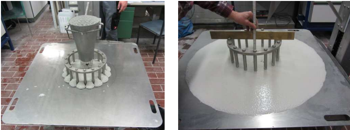
Abb. 4.5: Bestimmung des Ausbreitmaßes SF_J , der Fließzeit t_{500J} sowie der Blockierneigung PJ von M1, M2 und M3 gemäß DIN EN 12350-8
