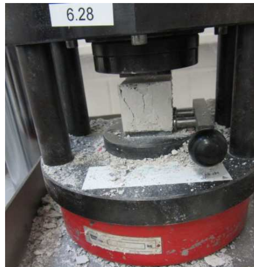
Abb. 4.13: Ermittlung der Betondruckfestigkeit in Anlehnung an DIN EN 12390-3
