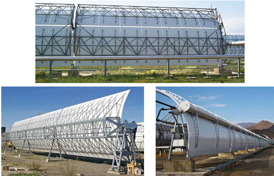
Abb. 2.4: Beispiele verschiedener Kollektorkonzepte Oben: LS3-Kollektor mit Raumfachwerk, unten links: Eurotrough mit Torsionskasten, unten rechts: SL4600 mit Torsionsrohr (Quelle: http://www.bine.info/themen/erneuerbare-energien/solare-waerme/publikation/solarthermische-kraftwerke-2/parabolrinnen-kollektortechnik/ , zuletzt zugegriffen am 17.12.2014)
