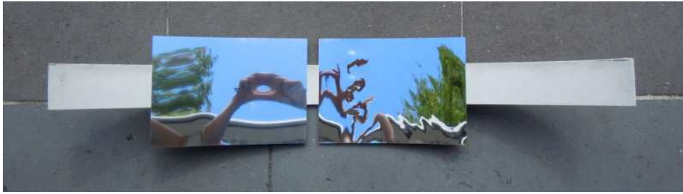
Abb. 8.12: Vergleich zweier Verspiegelungskonzepte, links: Aluminiumblech, rechts: selbstklebende Spiegelfolie
