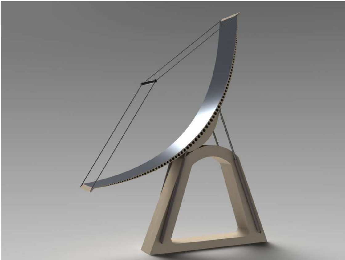
Abb. 9.1: Machbarkeitsstudie neue Parabolrinnengeneration aus hochfestem Beton (Animation: Firma solarsolid)
