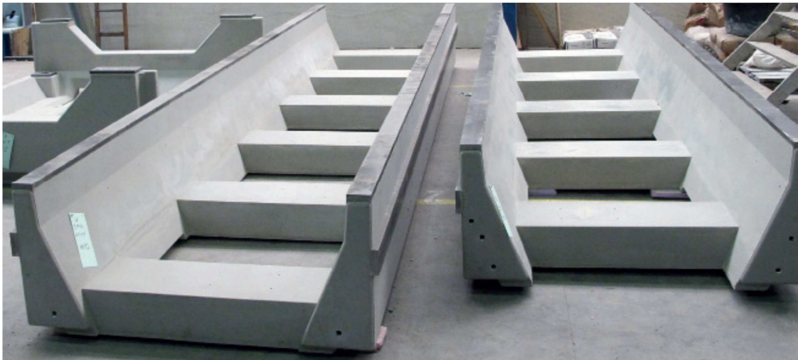
Abb. 4.2: Maschinenbetten aus Hochleistungsbeton (Quelle: Durcrete 2011 b )
