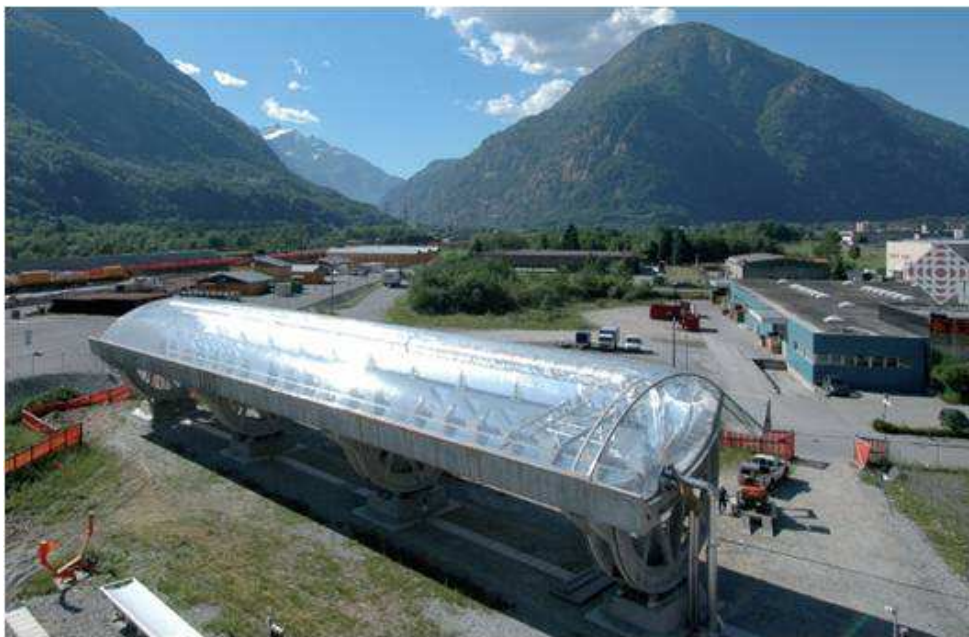
Abb. 3.3: Prototyp eines Betonkollektors mit pneumatischen Polymerspiegeln in Biasca, Schweiz (Quelle: http://www.pre.ethz.ch/research/projects/?id=airlight , zuletzt zugegriffen am 17.12.2014)
