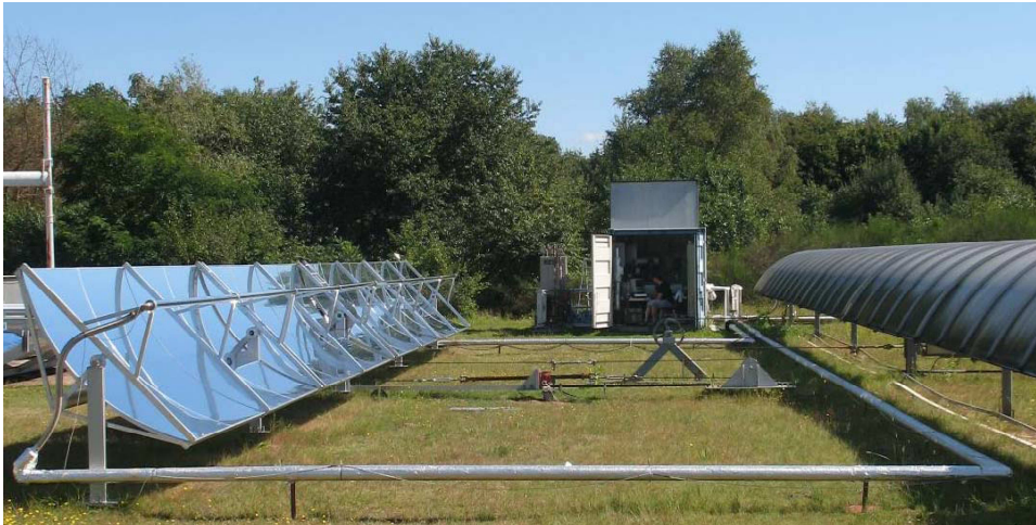
Abb. 3.2: PTC 1800-Kollektor auf dem DLR-Prüfstand Sopran in Köln-Porz (Quelle: Janotte 2009)
