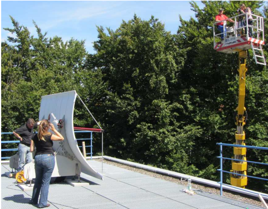
Abb. 5.15: Messverfahren 1 – Deflektometrie (TARMES)
