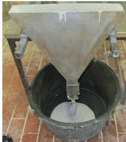
Abb. 4.7: Auslauftrichterversuch gemäß DIN EN 12350-9
