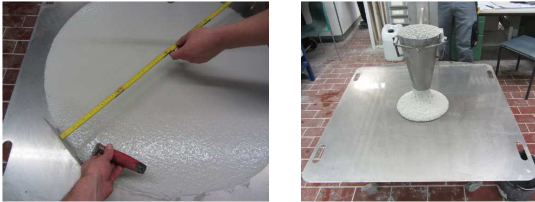
Abb. 4.4: Bestimmung des Setzfließmaßes SF sowie der t_{500} -Zeit gemäß DIN EN 12350-8
