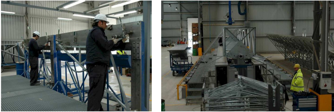
Abb. 2.8: Einstellvorrichtungen (Jigs) für die Serienfertigung von Kollektorelementen (Quelle: Nava 2007 a)
