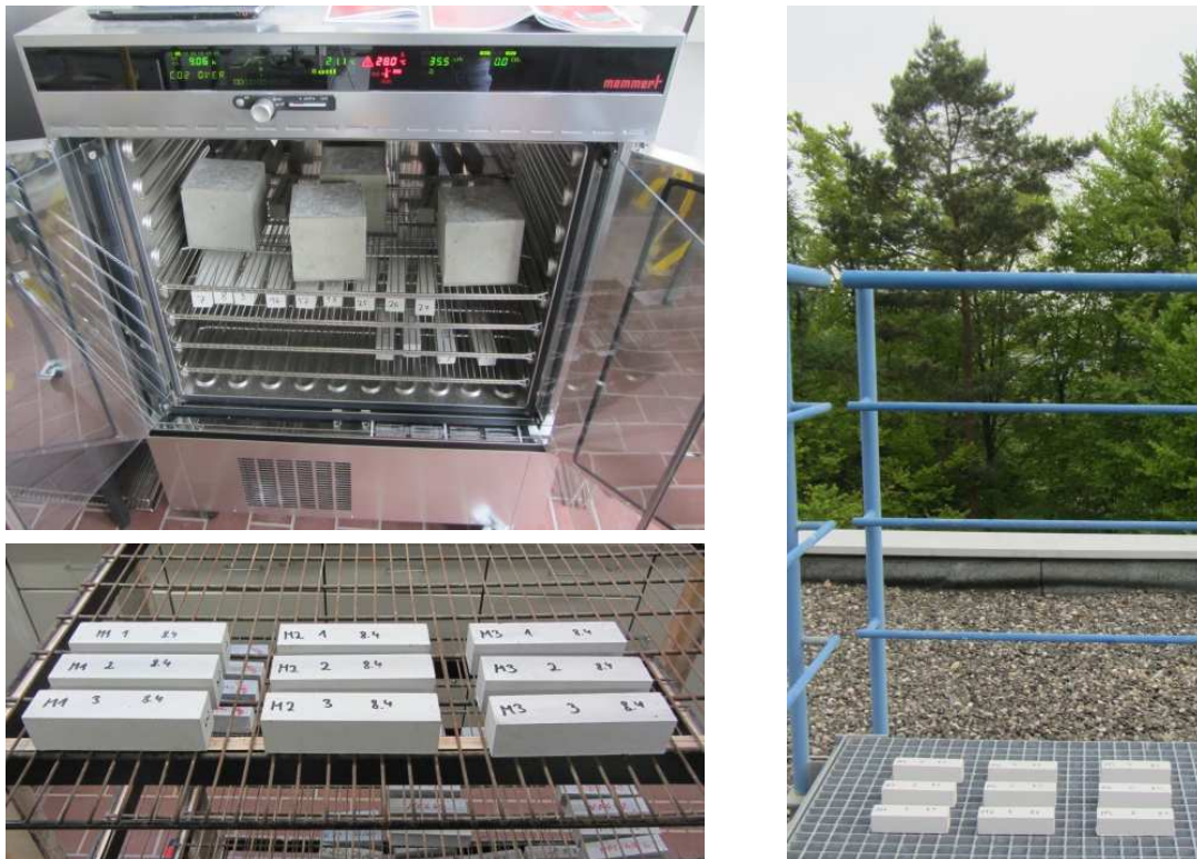
Abb. 4.23: oben links: Prismen im Prüfschrank mit erhöhtem CO 2 -Gehalt, unten links: Prismen unter Normklimabedingungen, rechts: Prismen unter Umgebungsbedingungen im Freien
