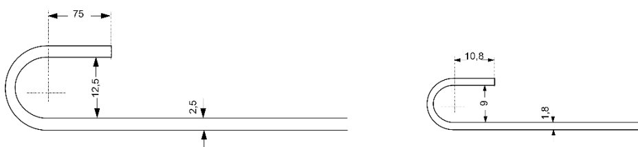
Bild 2.2: Warm gebogene Rundhaken nach Considerè aus DAfStb 14
