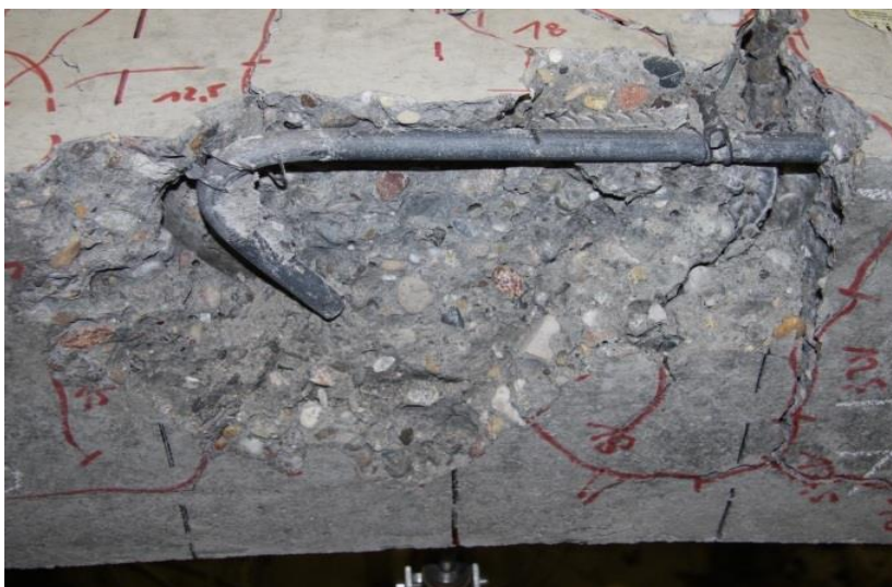
Bild 3.6: Versagen des Übergreifungsstoßes (Balken R7)
