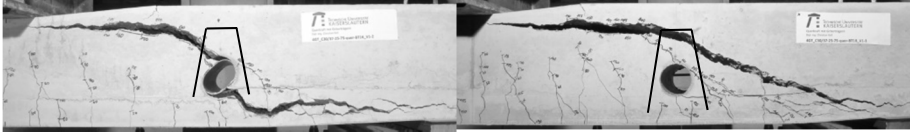
Abbildung 7-6: Vergleich der Bruchbilder mit Unterstützungskörben über der Leitung (links: auf das Fertigteil aufgestellt; rechts: ins Fertigteil einbetoniert)
