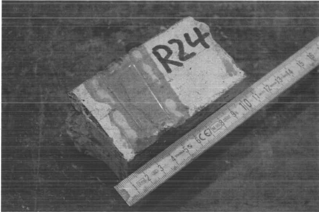
Abb. 51: Versuchskörper nach Verpressen und Ausschneiden der Risse, Serie 1 \phi 14\text{mm}
