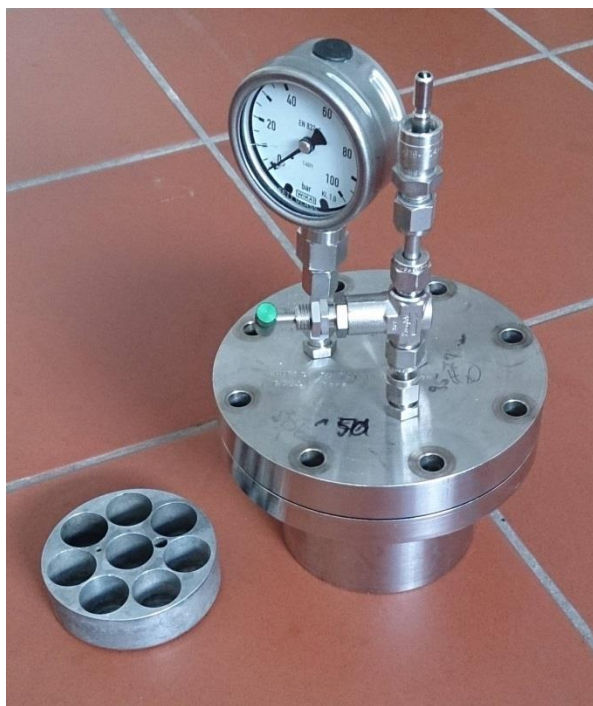
Abbildung 45. Edelstahl-Autoklav bis 100 bar mit Einsatz für acht Reaktionsvials.
