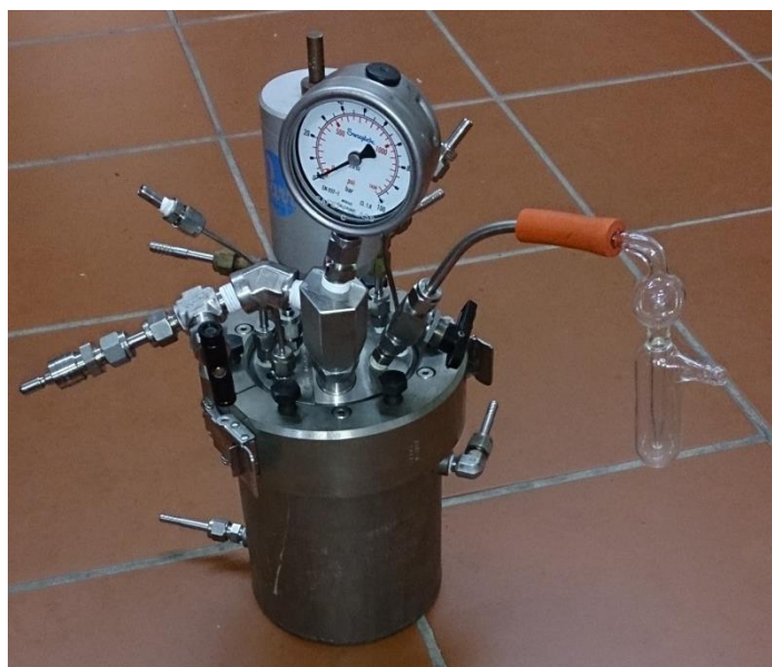
Abbildung 49. Parr 1 L Gasflussreaktor mit Zusatzkühlung.
