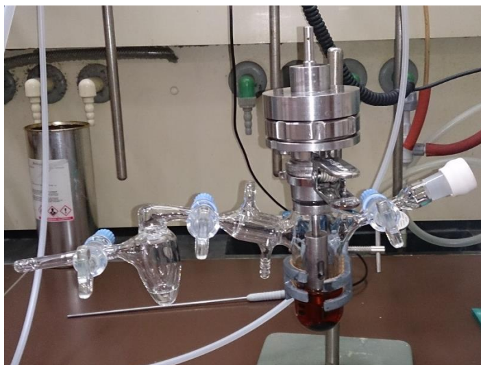
Abbildung 47. Glasreaktor für isomerisierende Metathesen im Gasstrom mit Begasungsrührer.
