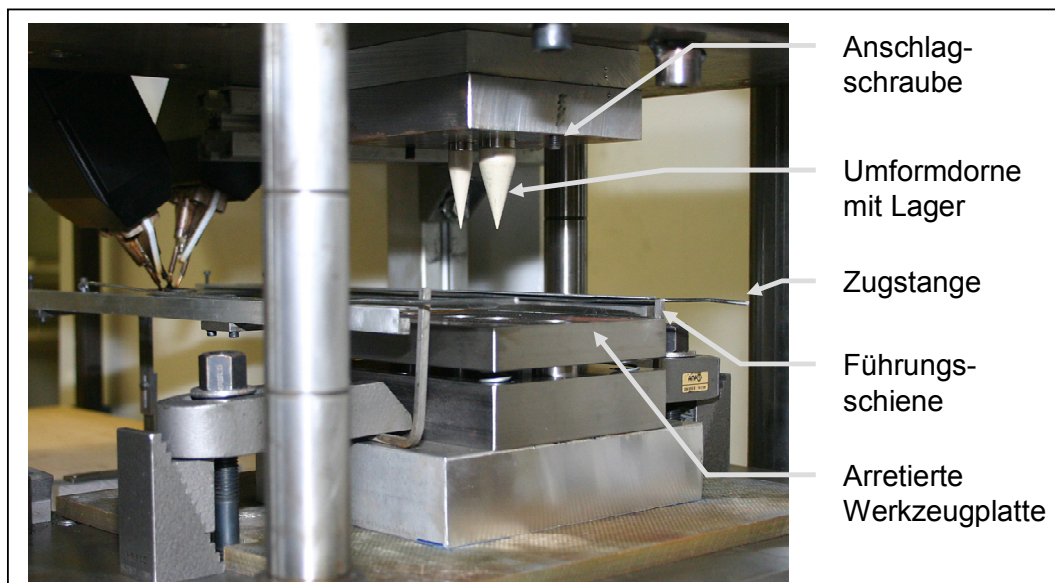
Bild 4.34: Umformwerkzeug zum Thermoformen und Lagerfügen (Phase 4)
