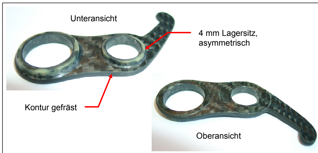
Bild 4.16: Fadenhebel mit einseitig umgeformten Lagersitzen und gefräster Kontur (Lagersitzhöhe h_{LS} = 4 \text{ mm} , CF/PA 66)
