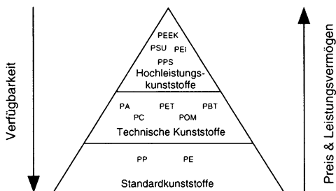
Bild 2.2 Auswahl möglicher Thermoplaste für Organobleche [50]
