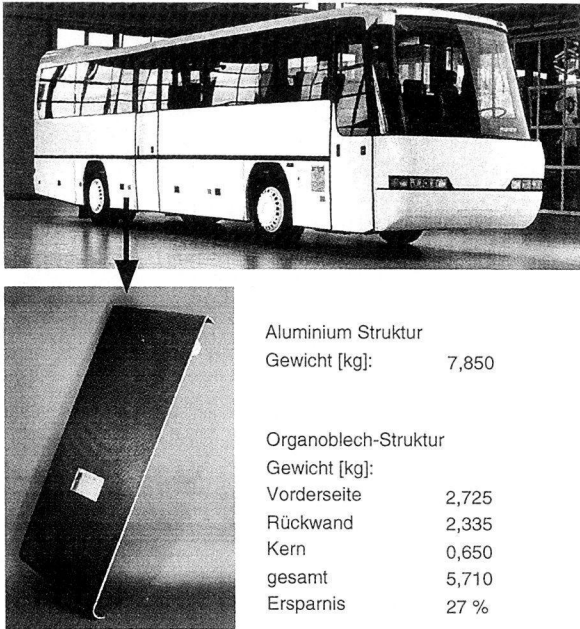
Bild 1.4 Organoblech-Ladeklappe eines Reisebusses [47]
