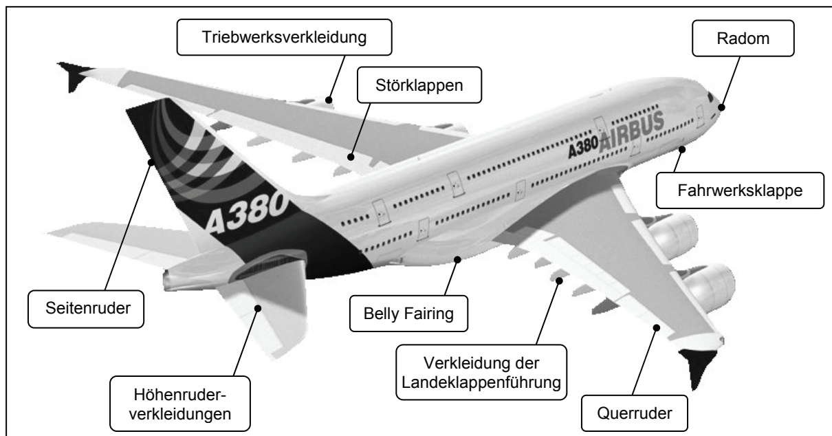
Bild 1.1: Sandwichstrukturen mit Wabenkern in externen Flugzeugkomponenten am Beispiel eines modernen Großraumflugzeugs (Airbus A380) [1]
