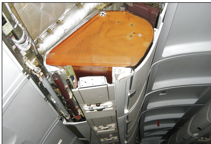
Bild 7.1: Seitliches Gepäckfach in GF/PF-Nomex ® -Sandwichbauweise (Airbus A310)
