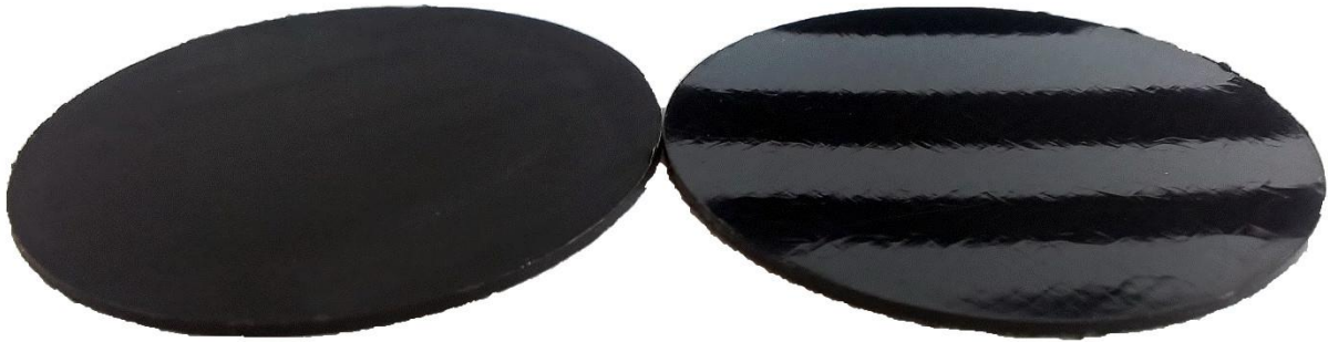
Abb. 4.8: Oberflächenwahrnehmung von Organoblechen mit vergleichbarer absoluter Welligkeit, links: W4, gestrahlt, rechts: W1, poliert
