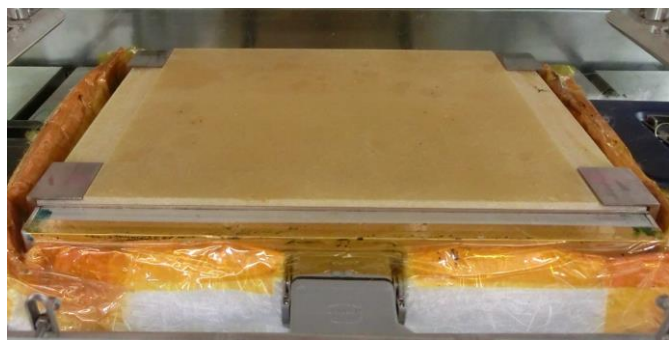
Abb. 6.5: Bilder der Werkzeugoberflächen mit links: spiegelnder Stahloberfläche, rechts: montierte Isolationsplatte mit matter Oberfläche
