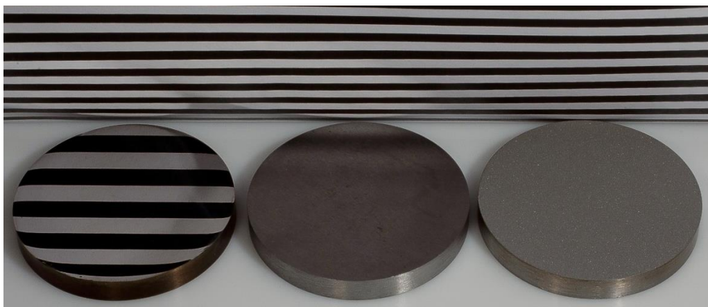
Abb. 4.2: Vergleich der Werkzeugoberflächen; links: poliert, Mitte: unbearbeiteter Werkzeugrohling, rechts: gestrahlt
