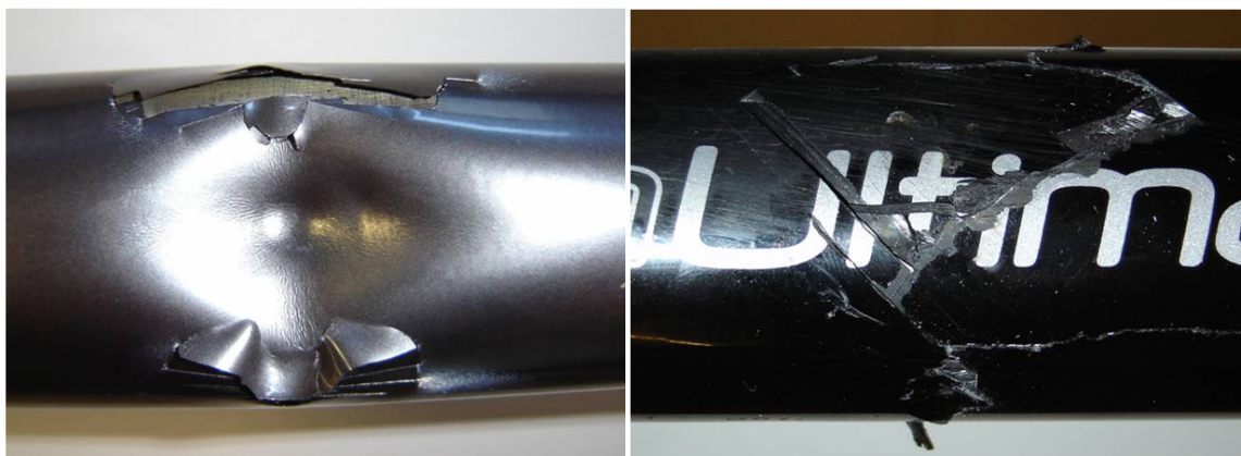
Bild 41: Beschädigung an Oberrohren von Rennradrahmen aus Aluminium, links, und aus CFK, rechts, nach Fall um 45° auf einen Impaktor mit einem Durchmesser von 20 mm
