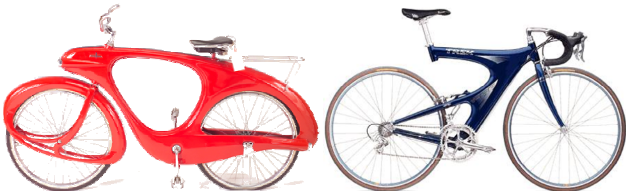
Bild 9: Spacelander von Benjamin Bowden mit Rahmen aus glasfaserverstärktem Kunststoff aus dem Jahr 1960 ([49], links), Y Foil von Trek mit Rahmen aus kohlenstofffaserverstärktem Kunststoff und Ausleger zur Erhöhung des Fahrkomforts 1998 ([50], rechts)
