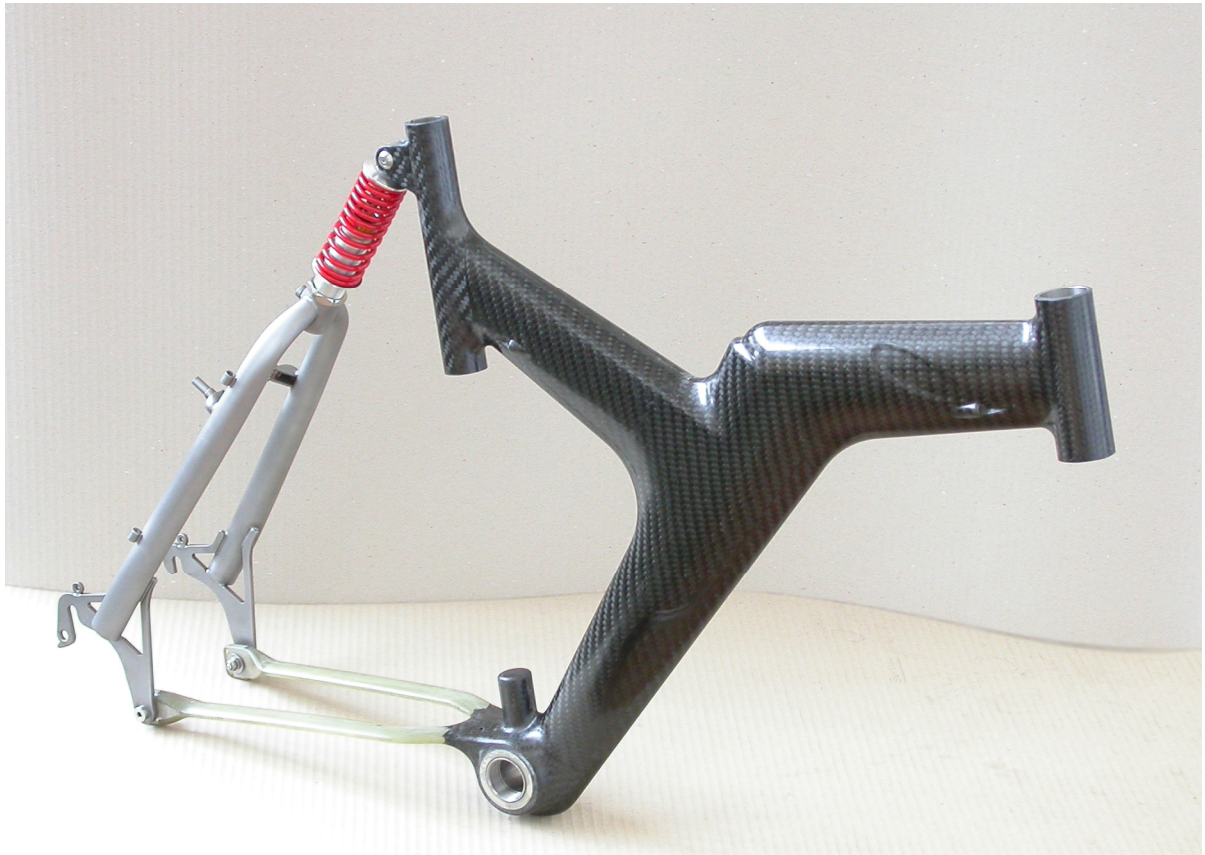
Bild 16: Rahmen von Villiger (Arrow Spyce) mit GFK-Blattfeder und Schaumkern, hergestellt im RTM-Verfahren [60]
