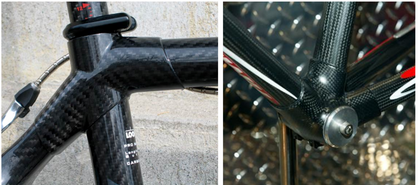
Bild 12: CFK Muffenbauweise: Look 585 Sitzrohrknoten (links) und Time VXRS Tretlagerbereich (rechts)
