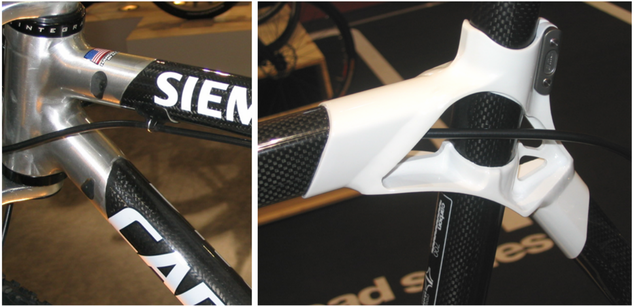
Bild 11: Metallische Muffenbauweise: Scalpel Cannondale Steuerkopf (links) und BMC SLC Sitzrohrknotenpunkts (rechts)
