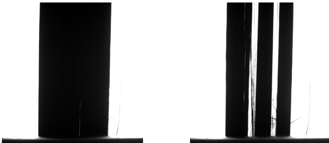
Abbildung 4.30: Analyse der Spreizung eines Rovings (vollständige / partielle Spreizung)
