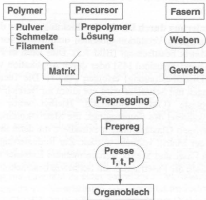
Bild 1.4: Prozeßkette zur Prepreg-Laminierung (○: Prozeß, □: Produkt)
