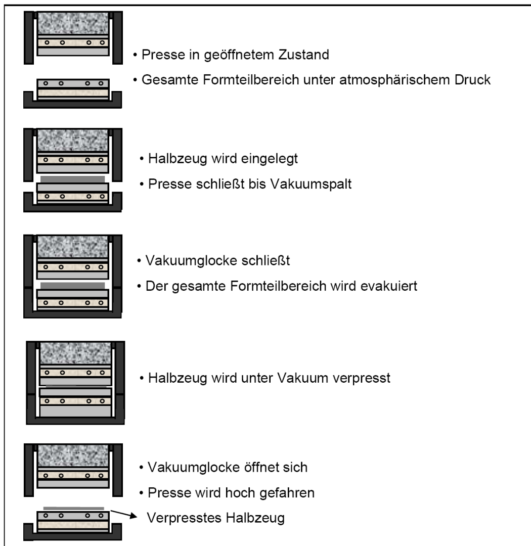
Bild 5.28: Schema des Pressvorgangs mit Einsatz einer Vakuummkammer
