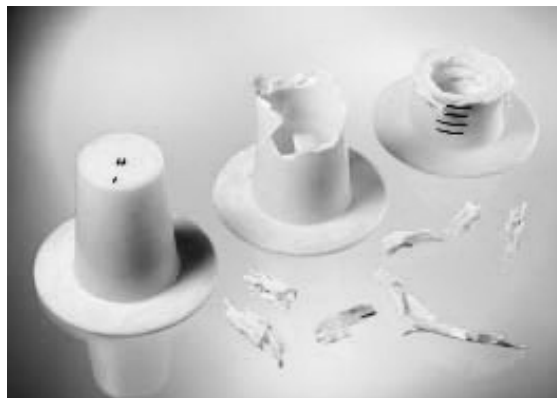
Bild 1.20: Fragmentierte LFT-Crashelemente (Prototypen) [Int03]
