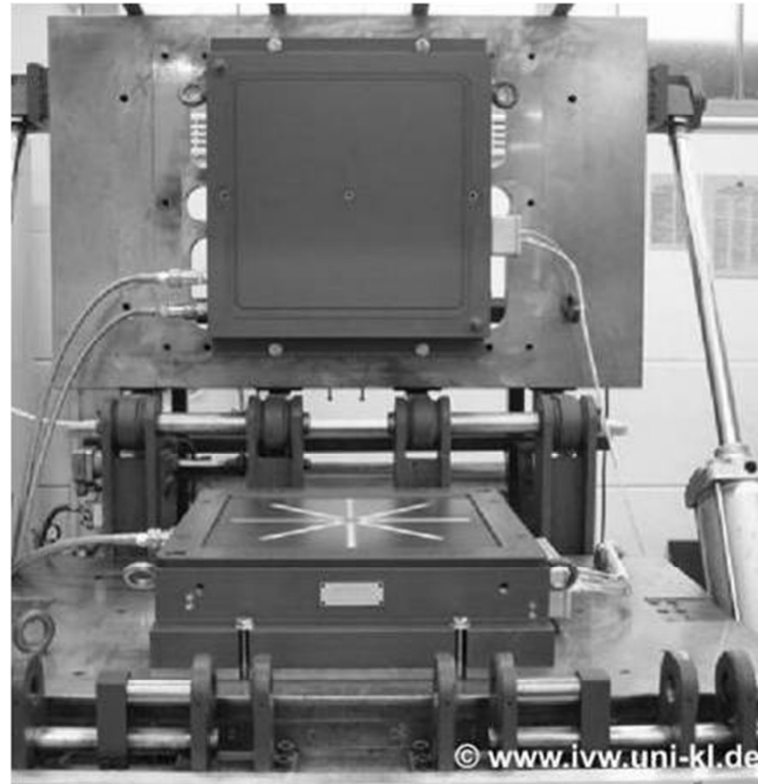
Abbildung 2.3: Die IVW Ebenenpermeabilitätsmesszelle '2D-COMP' mit kapazitiven Sensoren der 2. Generation von 2006
