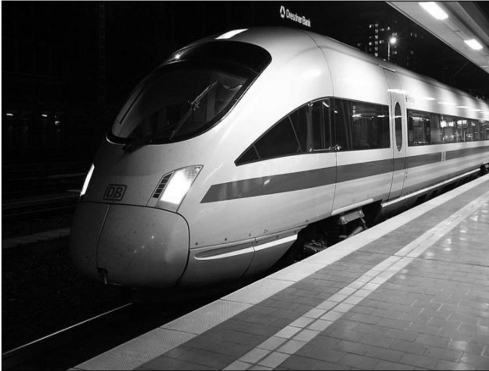
Bild 2.6: ICE mit FKV-Außenhaut [24]
