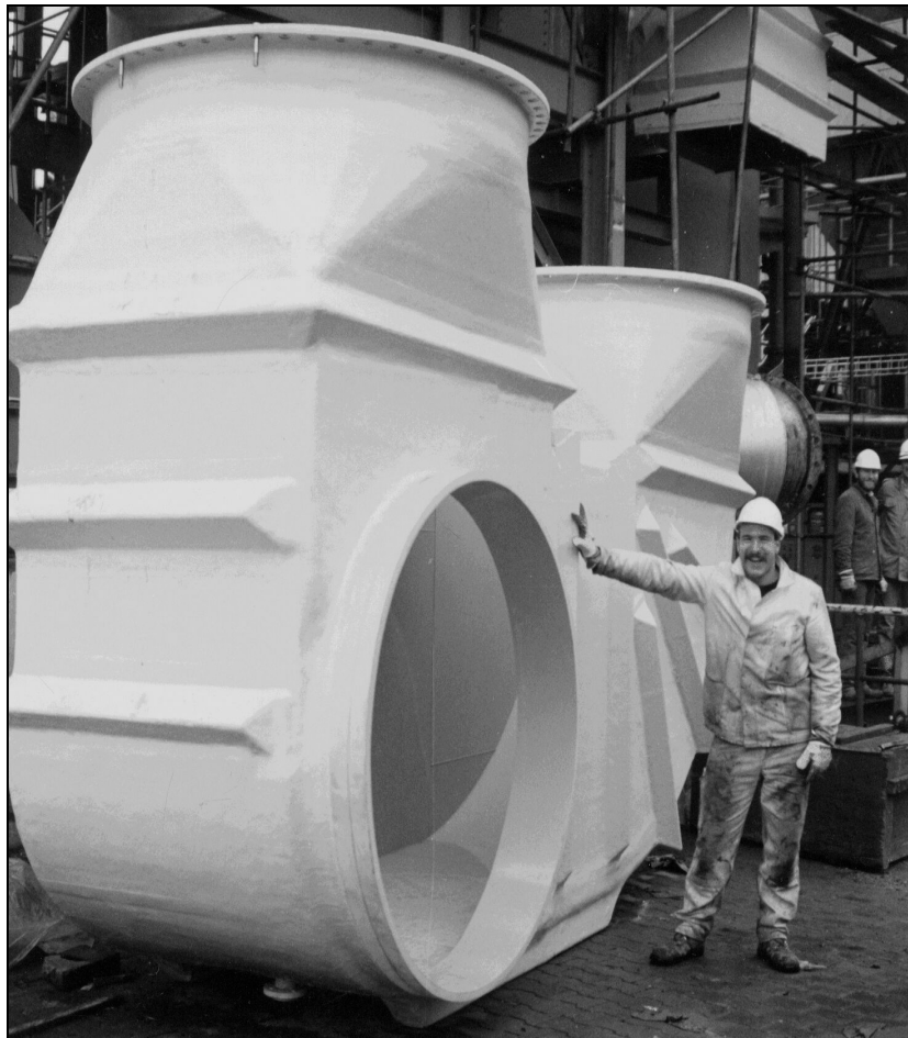
Bild 2.8: Abgaskanal aus GF-UP [26]
