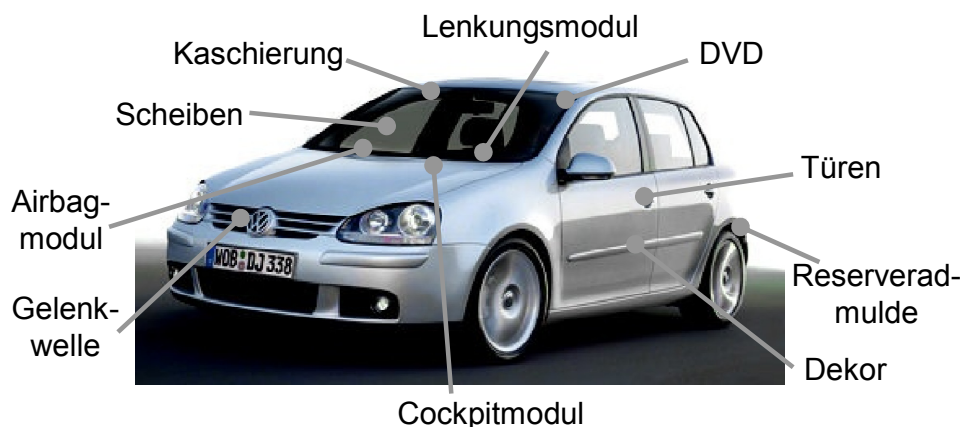
Abbildung 3: Beispiele für Klebverbindungen im Automobilbau [91]
