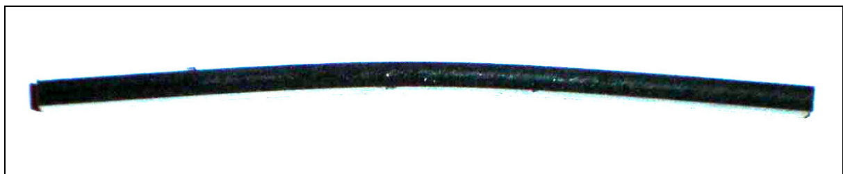
Abb. 5-5 Geprüfte Biegeprobe bei 1m/s
