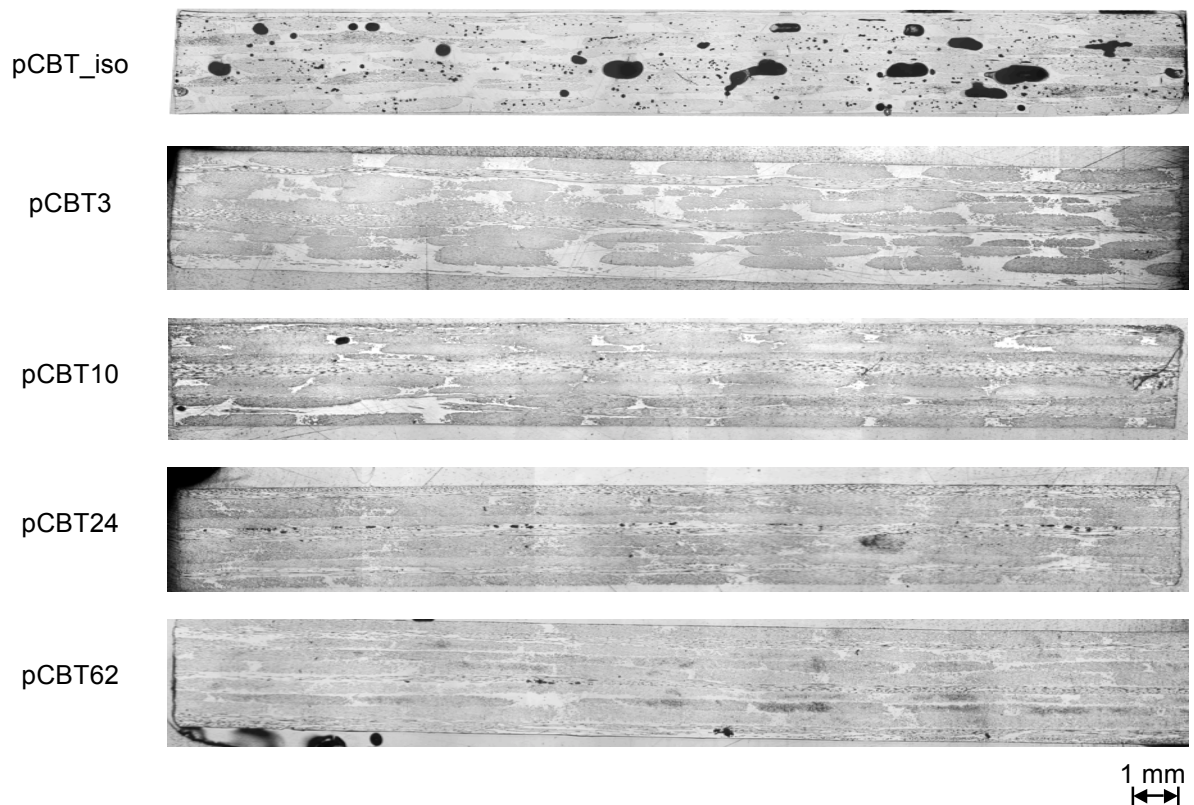
Abbildung 4.11: Schliffbilder pCBT-Lamine (vgl. Tabelle 4.1)
