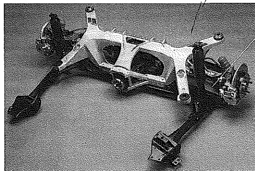
Bild 1.11: Mehrlenker-Hinterachse MULTILINK MK II des VOLVO 960 mit GFK-Parabel-Querblattfeder (Quelle: VOLVO).
