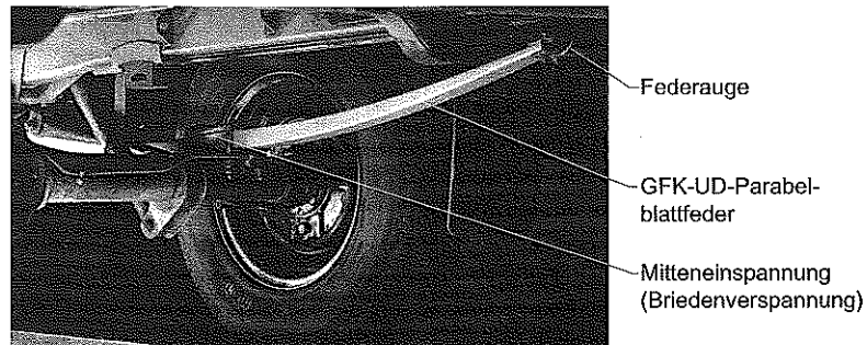
Bild 1.9: GFK-Parabelblattfeder für ein leichtes Nutzfahrzeug aus unidirektional glasfaserverstärktem Epoxidharz (GF-EP) (Quelle: BASF).
