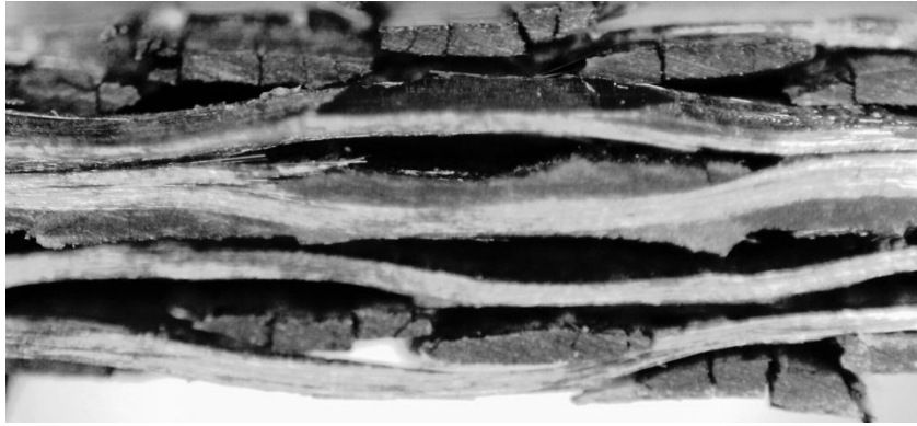
Abbildung 5.11: Seitliche Ansicht eines 660-Gewebe-Probekörpers nach einem Zugversuch
