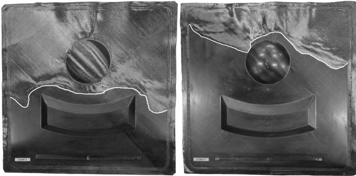
Abbildung 8.8: Short-Shot Versuche 1/3 d und 2/3 d, gespiegelt an der vertikalen Mittelachse dargestellt
