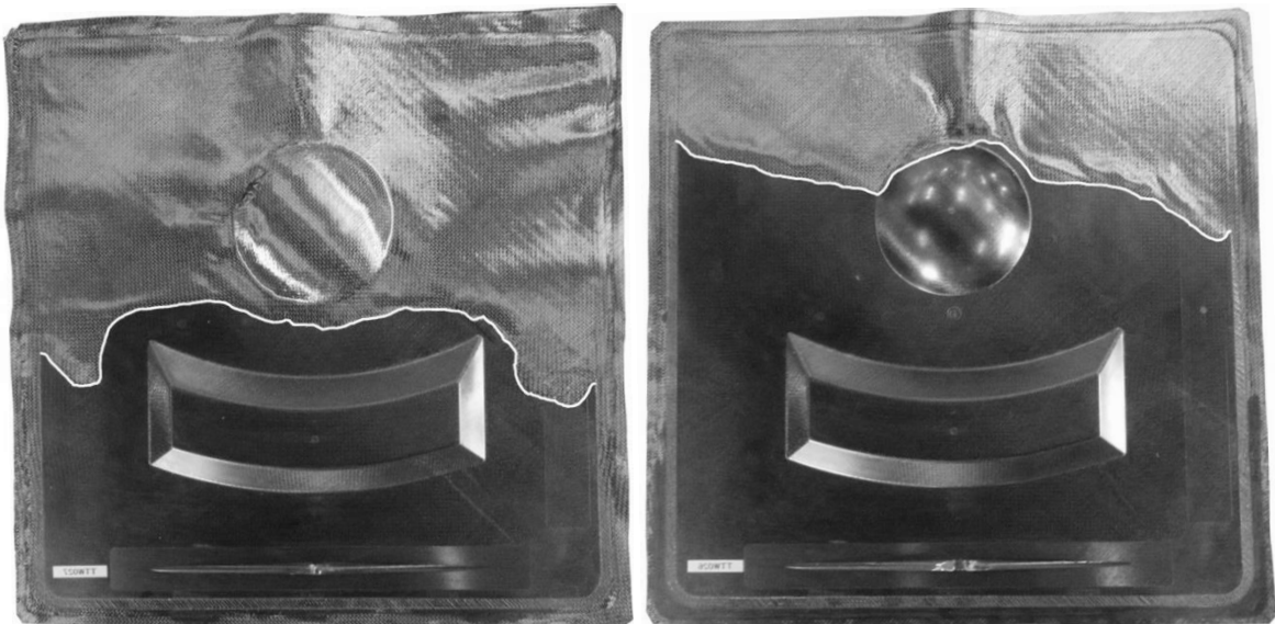
Abbildung 8.9: Short-Shot Versuche 1/3 e und 2/3 e, gespiegelt an der vertikalen Mittelachse dargestellt
