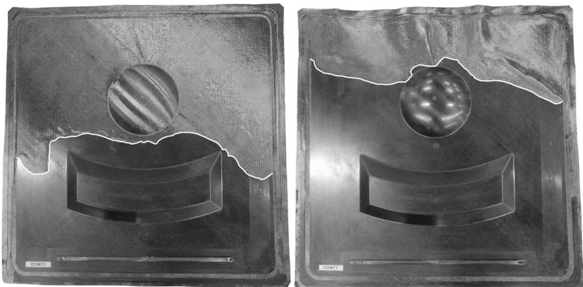
Abbildung 5.6: Short-Shot Versuche 1/3 c und 2/3 c, gespiegelt an der vertikalen Mittelachse dargestellt
