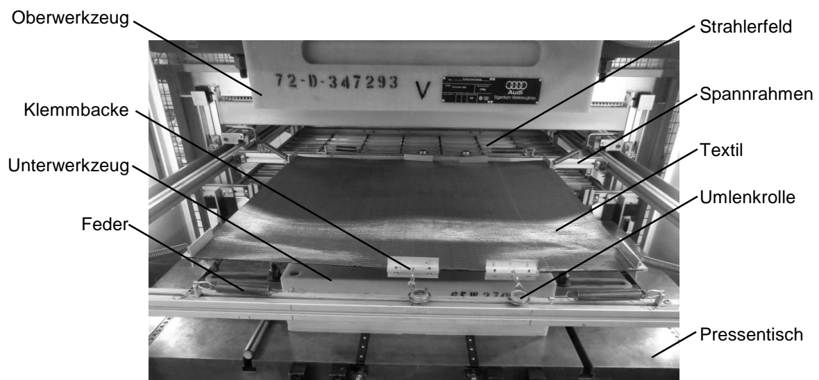
Abbildung 4.5: Preformingwerkzeug des TTW in der Presse mit Spannrahmen und Textil
