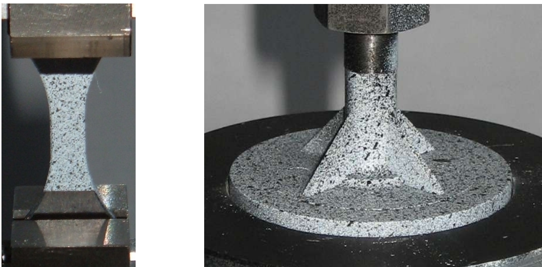
Abb. 4.16: eingespannte, kodierte Probekörper aus faserverstärktem Polypropylen, Zugprobekörper (links), Bauteildemonstrator (rechts)
