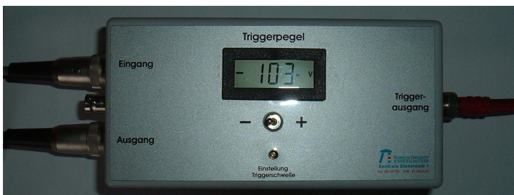
Abb. 4.13: Triggerbox für SchnellzerreiBversuche
