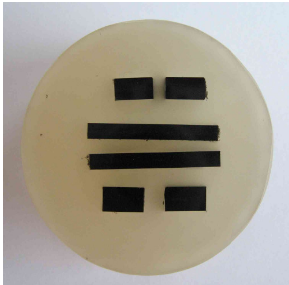
Abb. 5.18: eingebettete Zugproben aus PP-LGF
