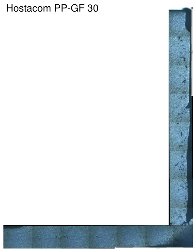
Abb. 5.39: Mikroskopaufnahmen der Schnittfläche aus Abb. 5.38 c), Bereich unter der Rippe (horizontal), Tubusbereich (vertikal) der Langfaser- und Kurzfaservariante (links bzw. rechts), 16-fache Vergrößerung
