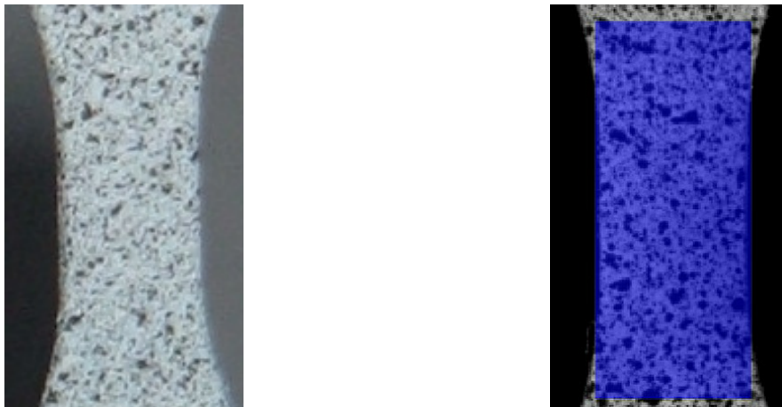
Abb. 6.11: Aufnahme- (links) und Auswertebereich (rechts) der Zugprobekörper, v \leq 1 m/s, Auflösung: 128 x 240 Pixel
