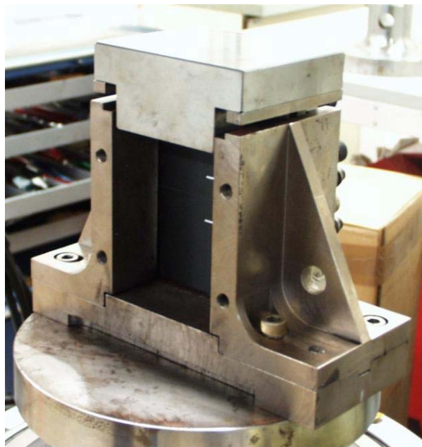
Bild 26: CAI - Einspannvorrichtung für statische und zyklische Druckversuche
