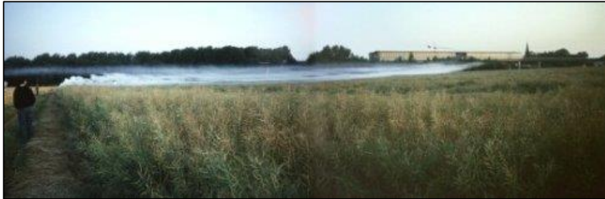
Abb. 10: Rauchschwadenexperiment zum Kaltluftnachweis [UNIVERSITÄT DUISBURG-ESSEN 2017, O. S.]
