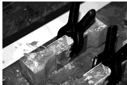
Abb. 4.3: Verkleben von Haftzugprobekörpern (hier mit geneigter Klebfuge)
