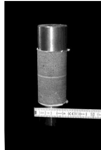
Abb. 5.9: Fertiger Probekörper. Bohrkern mit Klebfuge
