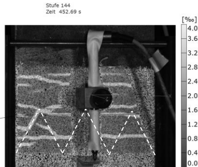
Abb. 5.48: Mit Hilfe der Photogrammetrie erfasste Dehnungsverteilung im Falle von Versuch Z3-WSG-60-03 bei einer Last von rund 42 kN unmittelbar vor dem Versagen (Stelle 60-2)
