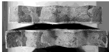
Abb. 5.62: Bruchflächen bei Versuch Z4-FJ-D2-SA-45-03
