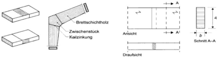
Abb. 5.30: Keilzinkenverbindungen nach DIN 1052:204-08. Von links nach rechts: keilgezinkte Einzelquerschnitte, keilgezinkte Rahmenecke, Universal-Keilzinkenverbindung zweier Brettschichtholzbauteile (Neuhaus 2011)
