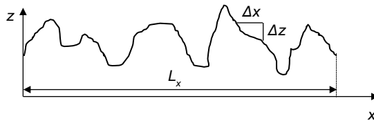
Abb. 2.19: Prinzipische Skizze zur Ermittlung des Wenzel'schen Quotienten
