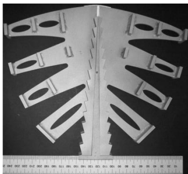
Abb. 1.1: Implantat zur Einleitung konzentrierter Lasten in schlanke Bauteile ( Kobler 2013 )
