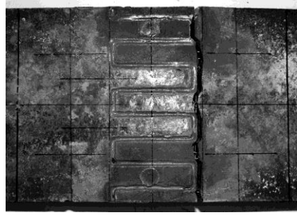
Abb. 4.43: Rissbild auf der Unterseite des Probekörpers bei Versuch B1-MR-WSG-RT-01
