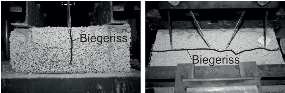
Abb. 6.15: Typisches Versagen durch Biegebruch der Leichtbetonplatte
