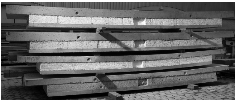
Abb. 6.41: Seitenansicht von Versuchskörpern aus Normalbeton
