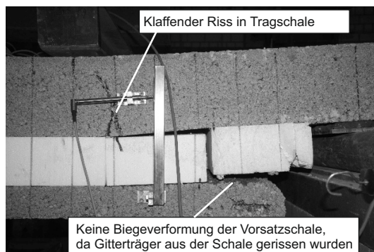
Abb. 6.38: Versagensbild von Versuchskörper B3-200-120-80
