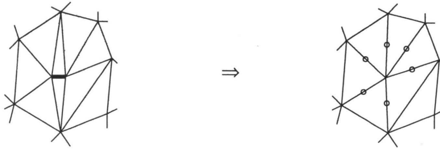
Bild 1: Entfernen einer zu stark gestauchten Feder
