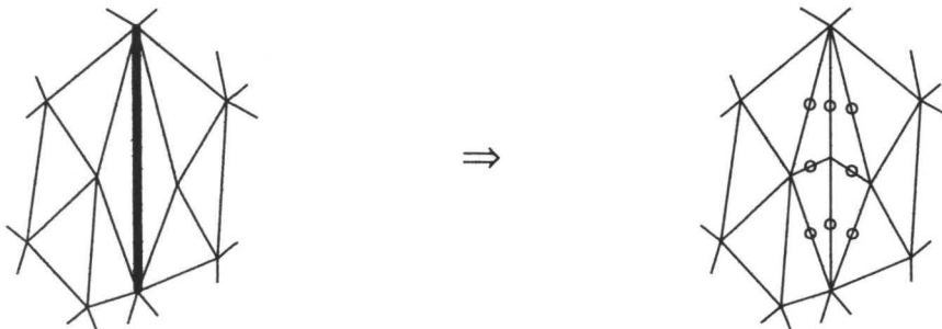
Bild 2: Einfügen neuer Federn anstelle einer stark gedehnten Feder
