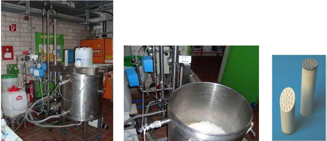
**Abbildung 4.14: biologische Denitrifikation Anlage (links) [4], 190 L Gefäß als Bioreaktor (Mitte), Keramik Membran (rechts) [74]**
