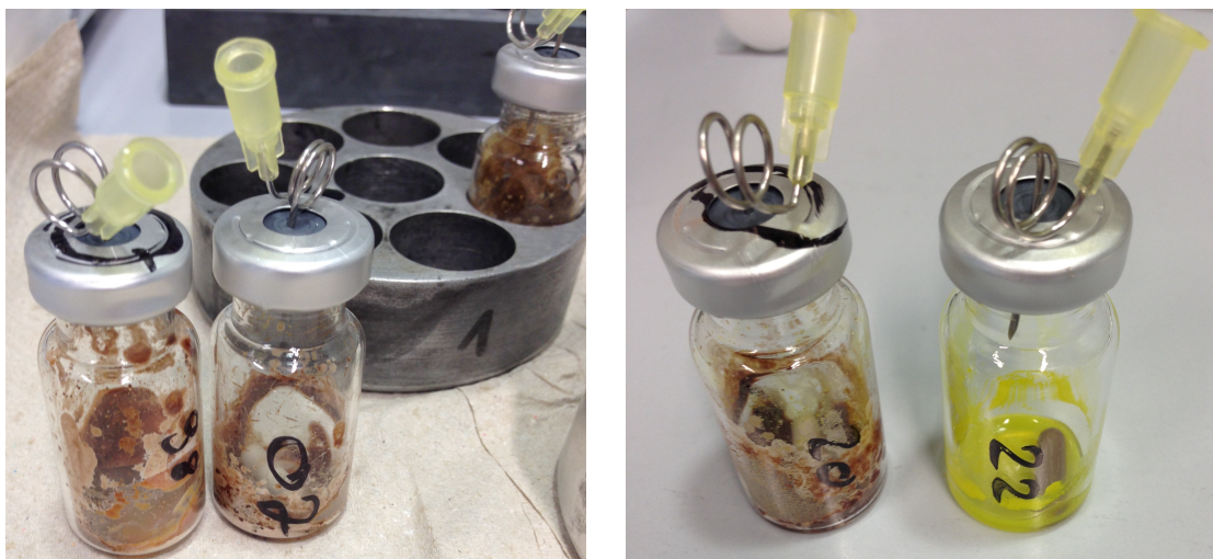
Abbildung 14: Reaktionsmischungen nach Ablauf der Reaktionszeit. Gefäße mit der Beschriftung 98, 07 und 20 zeigen feste Reaktionsmischungen bei vollständigem Umsatz. Das Gefäß mit Beschriftung 22 zeigt die flüssige Reaktionsmischung bei Reaktionsführung in Abwesenheit von BPhen und damit ausbleibender Produktbildung.
