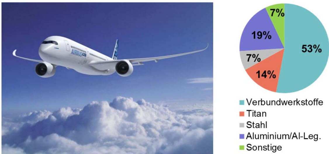
Abbildung 1-1: Werkstoffanteile am Strukturgewicht ziviler Flugzeuge am Beispiel eines Airbus A350-900 XWB [7]
