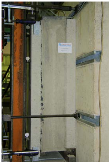
Abb. 3.77: Längsriß und Schubriß als typische Versagensart beispielhaft dargestellt anhand der Versuche SV-2 (links) und SV-C-2 (rechts)
