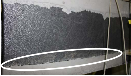
Abb. 3.54: Mäßiger Verbund zwischen unterer Tragschicht und Dämmstoffplatte am Beispiel von Versuchskörper BV-50-II.56-S12-C-1
