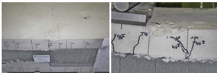
Abb. 3.47: Versagen der Biegedruckzone als sekundäre Versagensart in den Sandwichbiegeversuchen
