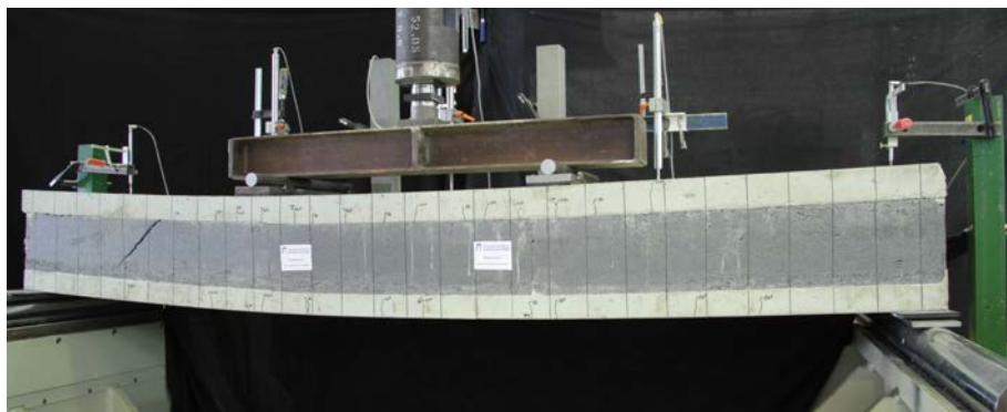
Abb. 3.41: Schubriss auf der linken Seite des Versuchskörpers sowie Riss im Bereich der Fuge zwischen der oberen Tragschicht und dem Dämmstoff oberhalb des linken Auflagers am Beispiel von Versuchskörper BV-50-I.90-S12-B-2
