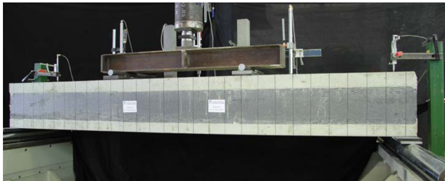
Abb. 3.40: Rissbild im definierten Grenzzustand der Gebrauchstauglichkeit am Beispiel von Versuchskörper BV-50-I.90-S12-B-2
