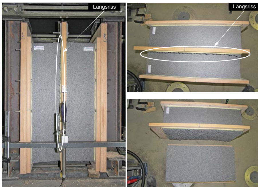
Abb. 3.15: Längsriss als typische Versagensart der Scherversuche am Doppelprobekörper am Beispiel des Probekörpers SM1-3
