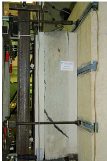
Abb. 3.77: Längsriß und Schubriß als typische Versagensart beispielhaft dargestellt anhand der Versuche SV-2 (links) und SV-C-2 (rechts)
