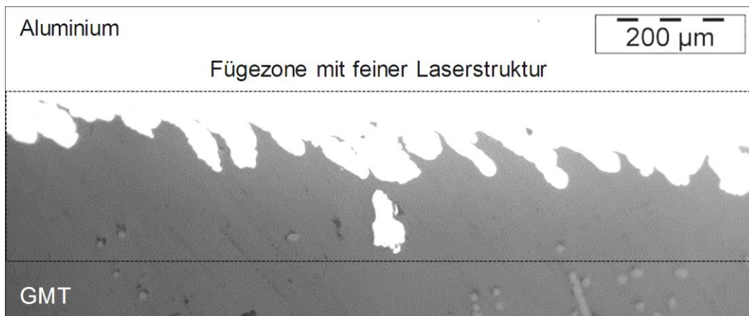
Abbildung 6.4: Schliffbild der Fügezone zwischen GMT und Aluminium (feine Laserstruktur), erzeugt im zweistufigen Schweißprozess
