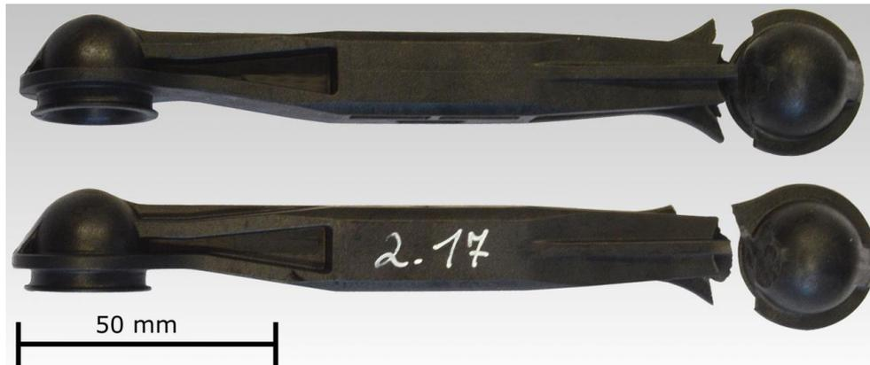
**Abbildung 6.7: Bruchbild der Koppelstange unter zyklischer Last bei Spannungsverhältnissen von  $R=0,1$  (oben) und  $R=-1$  (unten)**
