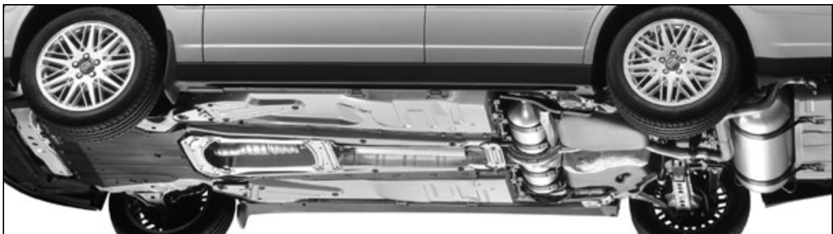
Bild 1.3: Unterbodenansicht des Volvo S80 bifuel [16]
