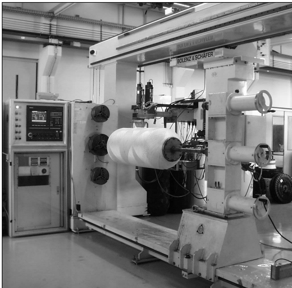
Bild 2.1: Bolenz & Schäfer Portalwickelanlage mit 6 Achsen der Institut für Verbundwerkstoffe GmbH
