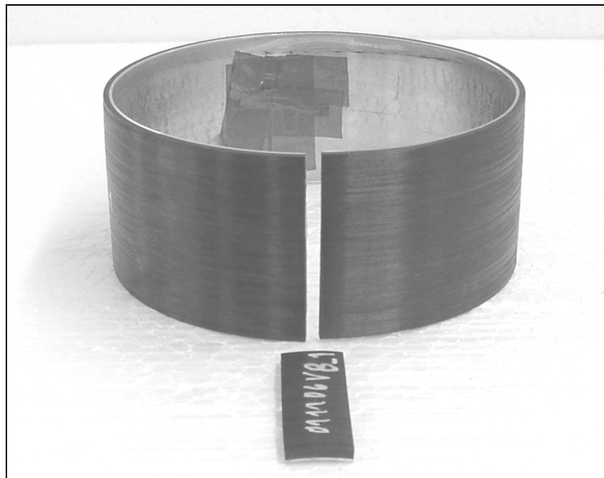
Bild 4.4: Ringprobekörper mit Zugspannung auf der Ringinnenseite und Druckeigenspannung auf der Außenseite. CF/PEEK, 10 Lagen, Kerntemperatur 260 °C, Auslagerungszeit 20 min bei 260 °C, Umfangswicklung, Aluminiumliner, Bandkraft 5 N
