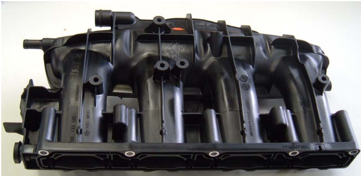
Abb. 3.19: Kunststoffansaugrohr, PA6-GF 30, Mann & Hummel, Ludwigsburg
