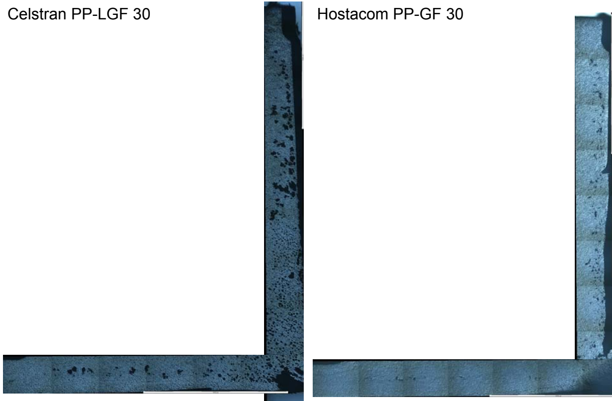
Abb. 5.39: Mikroskopaufnahmen der Schnittfläche aus Abb. 5.38 c), Bereich unter der Rippe (horizontal), Tubusbereich (vertikal) der Langfaser- und Kurzfaservariante (links bzw. rechts), 16-fache Vergrößerung
