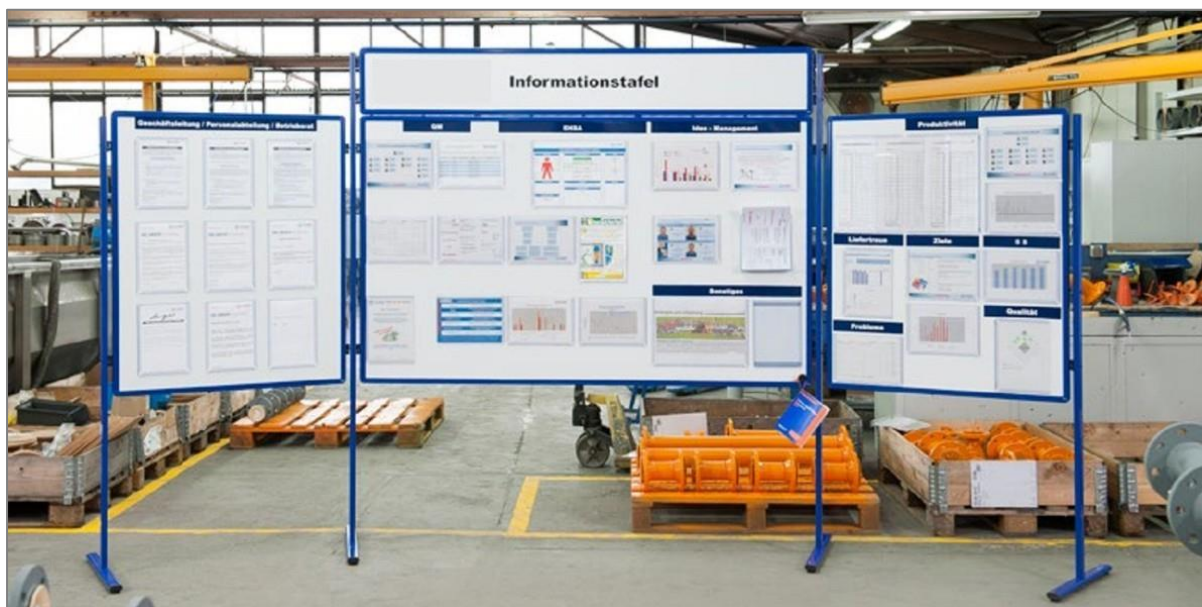
Abbildung 35 Beispiel für eine Shopfloor-Tafel in der Produktion (Quelle: [WEI])
