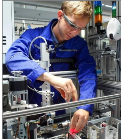
Abbildung 2 Beispiel für den Einsatz von Augmented Reality und Datenbrillen für Wartungsarbeiten in der Produktion (Quelle: Technologie-Initiative SmartFactory KL e.V.)
