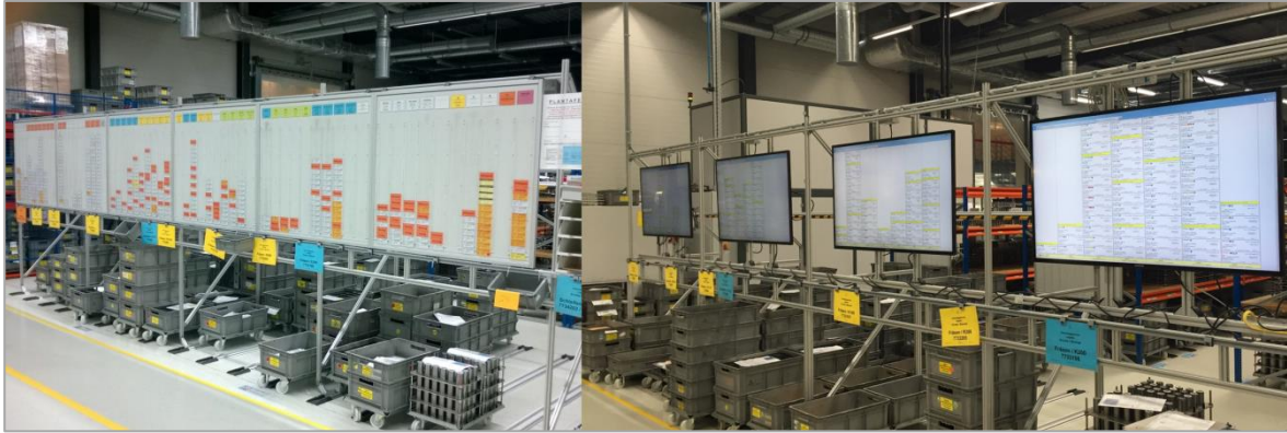
Abbildung 41 Herkömmliche (links) und digitalisierte (rechts) Heijunka-Tafel (Quelle: Wittenstein AG)
