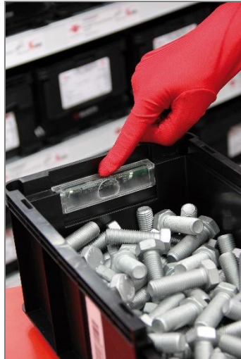
Abbildung 40 Das iBin-Behälter- und Bestellsystem (Quelle: Würth Industrie Services GmbH & Co. KG)
