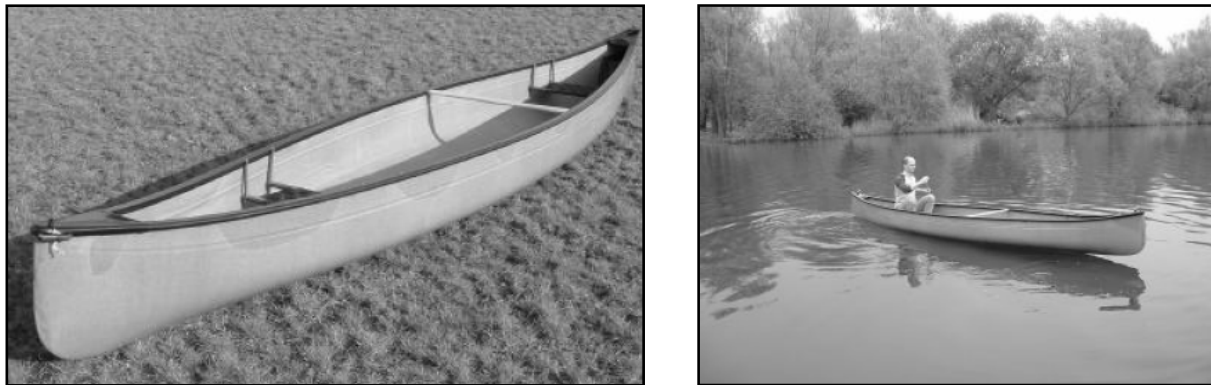
Bild 2.12: Kanadier-Boot aus naturfaserverstärkten Kunststoffen [87]
