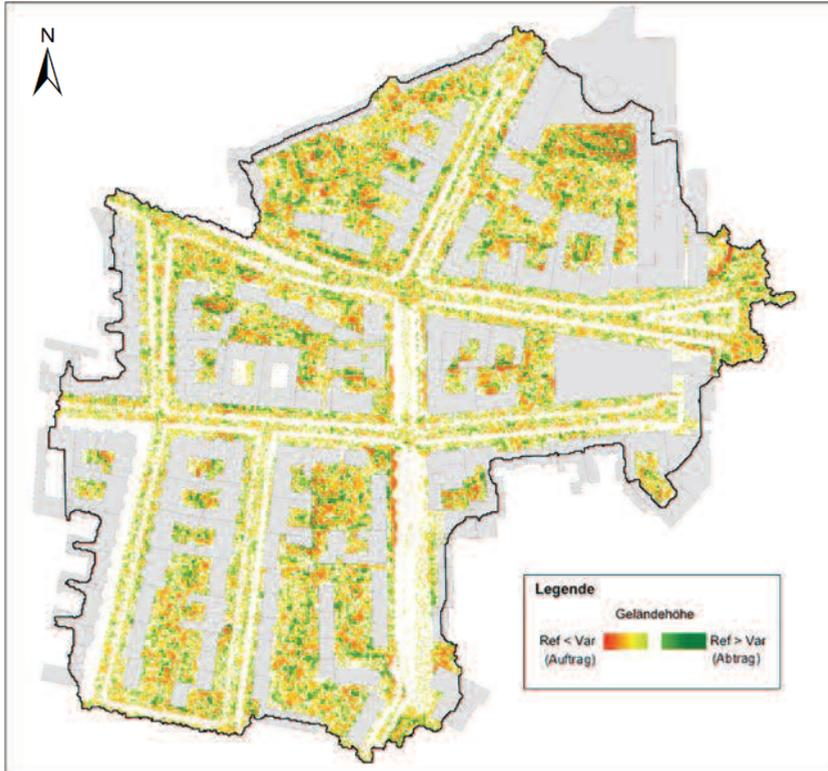
Abbildung 5-8: Höhenunterschied zwischen den Oberflächenmodellen – Modellgebiet 1 – Referenzmodell/Variante 1. Rot: Variante 1 höher als Referenz, Grün: Referenz höher als Variante 1
