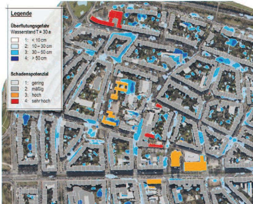
Abbildung 2-3: Beispiel einer Karte (Kartenausschnitt) mit kombinierter Darstellung ereignisbezogener Wasserstände (Überflutungsgefahren) sowie gebäude- und anlagenbezogener Schadenspotenziale (Illgen 2015 in DWA 2016)
