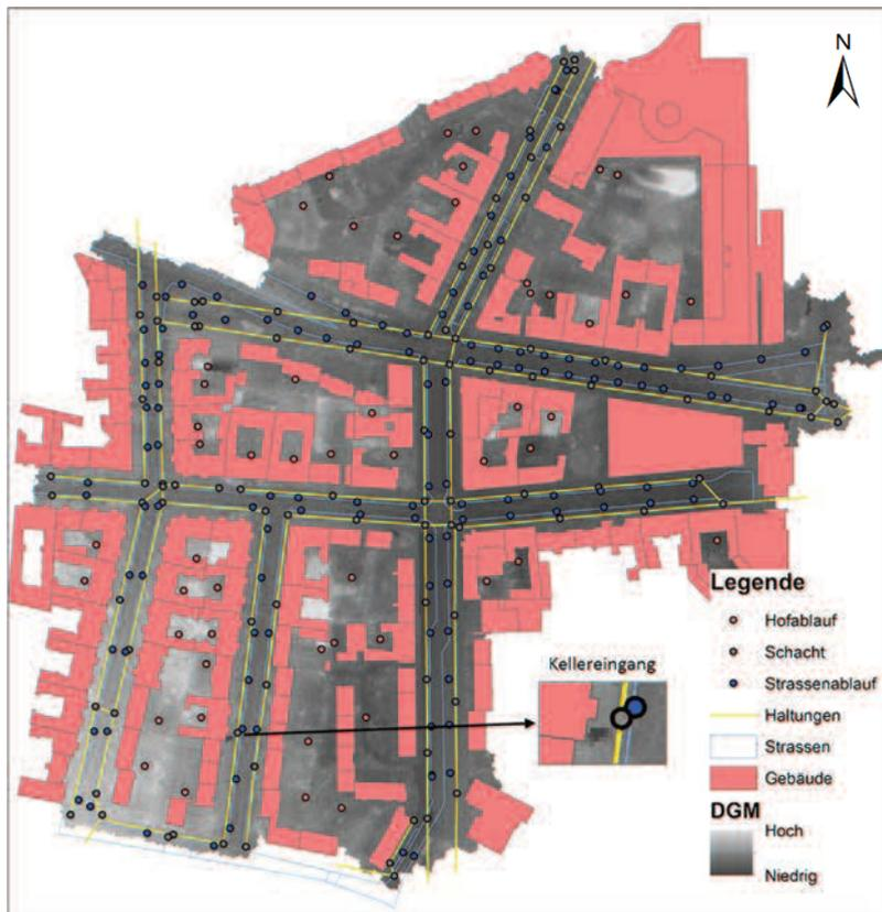
Abbildung 3-3: Modellgebiet 1 mit Darstellung des Geländemodells, der Gebäude und Straßen sowie der Knoten und Haltungen des Kanalnetzmodells.
