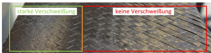
Abbildung 5.1: Folgen nicht planparalleler Sonotroden-Ausrichtung
