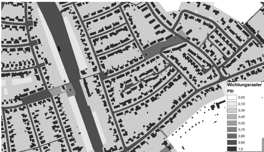
Abbildung 4-4: Beispiel eines Wichtungsrasters (Abflussbeiwerte) für die Fließwegakkumulation (eigene Darstellung)
