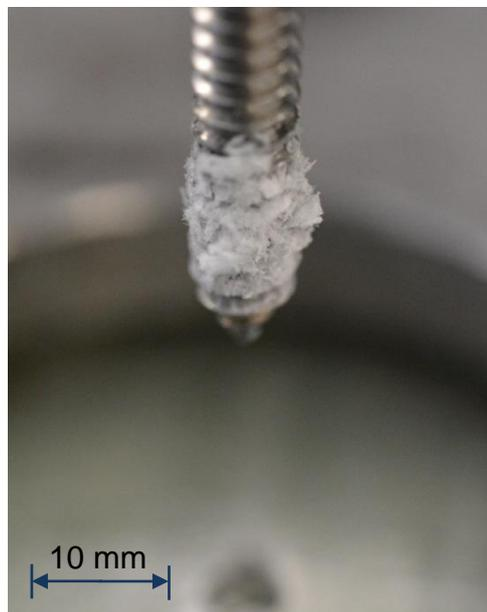
Abbildung 4.14: Abgescherte GFK-Reste im Gewinde der Schraube (ST8) bei geformtem Gewinde
