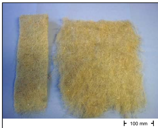
Bild 2.5: Leicht vereinzelbare textile Faserhalbzeuge
