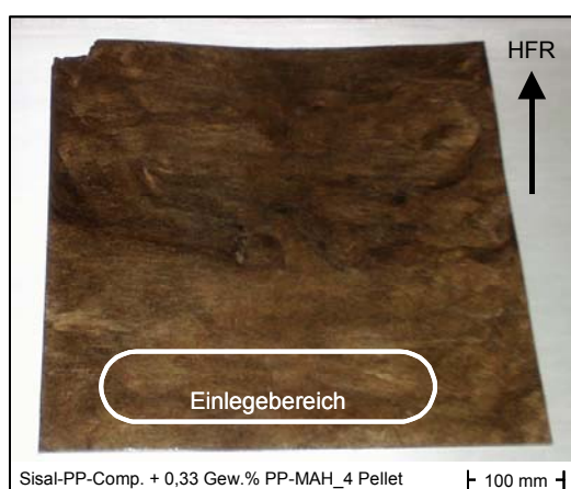
Bild 4.22: Sisal-PP-Compound-Platte mit 0,33 Gew.% PP-MAH_4 aus Pellets gepresst
