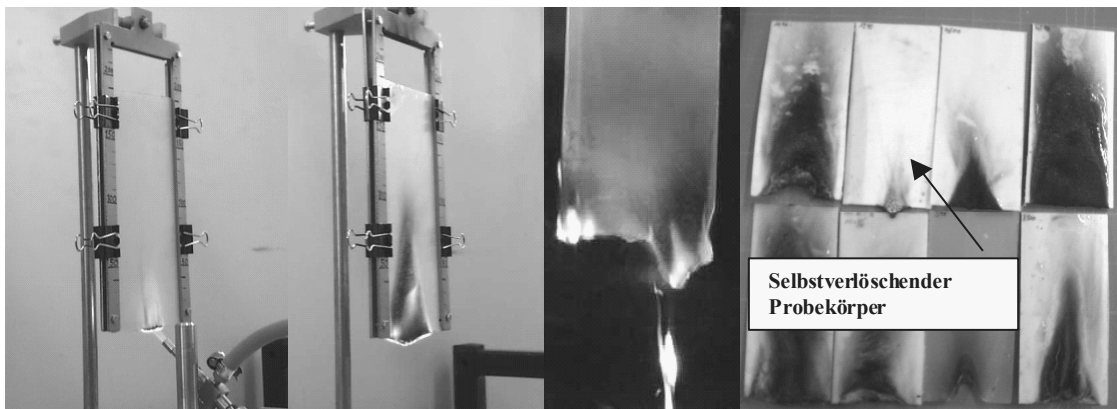
Bild 3.12 Beflammung von Probekörpern gem. DIN 53438 (Teil 2) (v.l.n.r.: Start Beflammung, Flammenausbreitung, brennend tropfende Probe, Gruppe von Probekörpern mit unterschiedlicher Brennbarkeit nach Beflammung)
