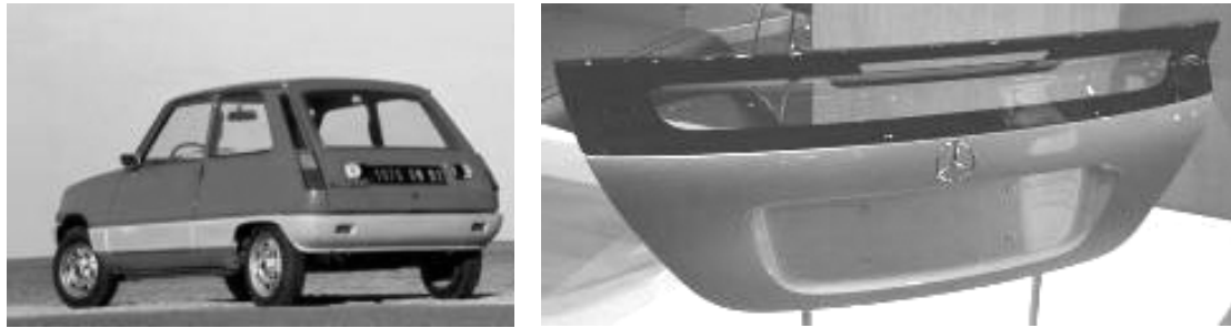
Bild 2.3: SMC-Applikationen im Automobilbereich gestern und heute (links: Renault 5 (Baureihe Jahr 1976 (Rundum SMC-Beplankung (Stoßfänger aus SMC bereits 1972)), rechts: Mercedes-Benz SMC-Heckklappenbeplankung lackiert des CL 203) [34]
