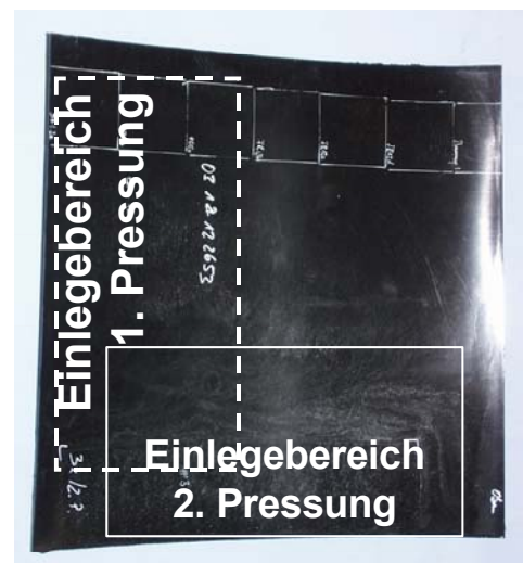
Bild 4.4: Schematische Darstellung (dunkelgrau: Einlegebereich, y: Fließrichtung) und Platte (konkave Ansicht) mit besonders stark ausgeprägtem Verzug
